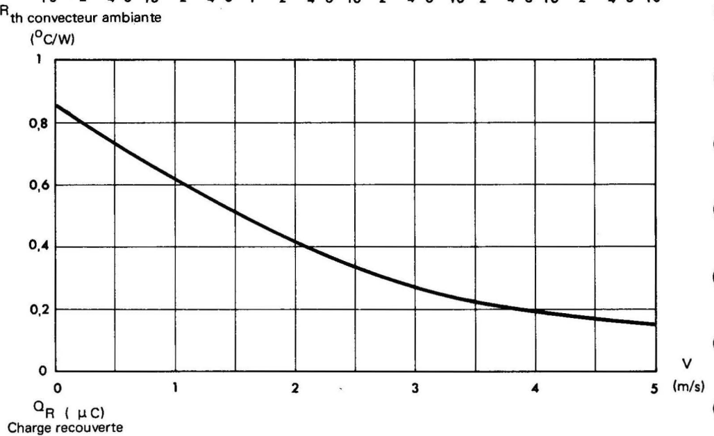
Fig.8 – Résistance thermique du convecteur TVF 100 en ventilation forcée en fonction de la vitesse d'air.
