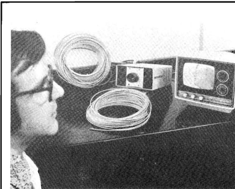
Photo 1. - T.V. à fibres optiques : les signaux vidéo modulent une diode électro-luminescente ; celle-ci est couplée, à un faisceau de fibres optiques de plusieurs centaines de mètres de longueur. A l'autre extrémité se trouve un détecteur relié au poste de télévision (photo Corning Glass Works).
