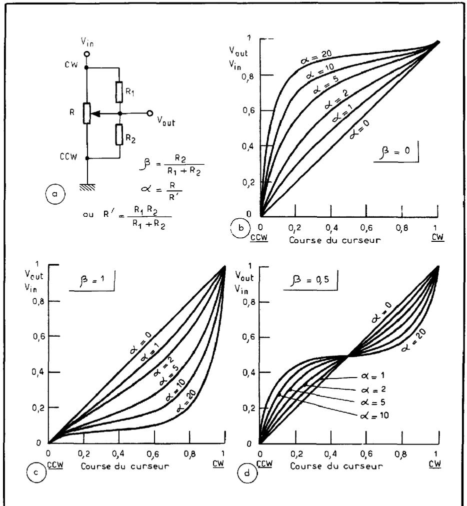
$(V_{out}/I_{in})$  par rapport à celui-ci, dans le cas où  $\beta = 0,5$  correspondant à  $R_1 = R_2$ . Le point d'intersection des courbes dépend de  $\beta$  et peut être déplacé en modifiant les valeurs de  $R_1$  et  $R_2$ .
