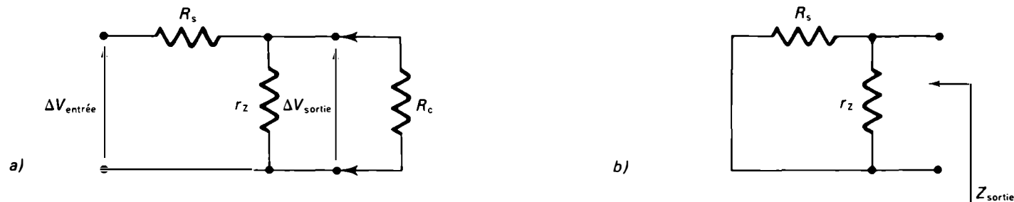
Figure 4.15 Circuits équivalents du régulateur de tension shunt pour: a) déterminer le facteur de stabilisation; b) déterminer l'impédance de sortie.
