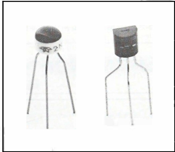
FIGURE 2-21 Transistors avec leurs câbles courbés, prêts pour le montage sur une plaque de circuit imprimé.
