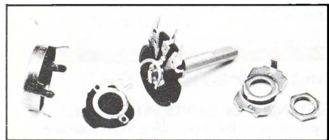
FIGURE 16-5 Construction d'une résistance variable.
