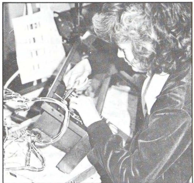
FIGURE 1-8 Une monteuse procède au filage d'un châssis métallique.
