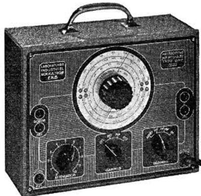
Cet appareil couvre, en 4 gammes, de 100 kHz à 32 MHz (3 000 m à 9,35 m).
