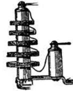
Ces sels de choc sont du type à bobinages nid d'abeilles montés sur colonnettes en stéatite, elles ont une très faible capacité répartie et sont prévues pour admettre une intensité de 600 mA
