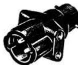
**Douille voleuse** en bakélite moulée, est composée d'une partie mâle à baïonnette, d'une partie femelle pour lampe standard culot baïonnette, et de 2 prises de courant femelles écartement 4x19 (10A-250V).
