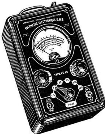
Voltmètre à haute impédance, à lecture directe, pour continu et alternatif, de 10 c/s à 50 Mc/s, cet appareil permet les mesures suivantes :
