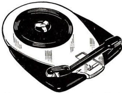
Commutateur des vitesses 16 - 33 - 45 et 78 tours par levier comportant une position de débrayage, assurant la coupure de l'alimentation du moteur et l'immobilisation du bras sur son support.
