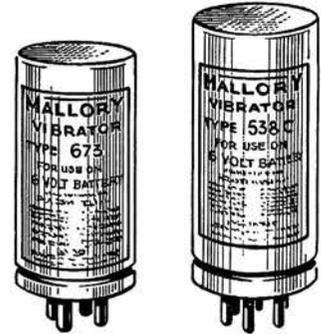
Les vibreurs Mallory ont une lame vibrante mécaniquement synchronisée et se font pour des tensions d'alimentation variées. Pour chacun des vibreurs les tensions indiquées sont celles mesurées entre la lame vibrante et le point milieu du transformateur ; de même les courants maxima sont indiqués pour un fonctionnement permanent sur la tension maximum, et à une température ambiante de 30°C. Ils peuvent fonctionner jusqu'à 85°C. Ces vibreurs se font en 3 séries. Fréquence 115 p.p.s.
