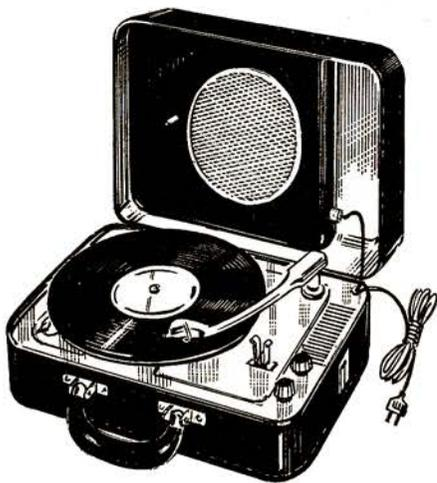
L'électrophone « ECO » type Présence est équipé d'un amplificateur donnant une puissance modulée de 3 watts, et d'un ensemble tourne-disques « ECO ». Le haut-parleur de 17 cm, d'un modèle spécial, est fixé dans le couvercle de la mallette.
