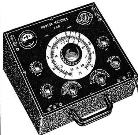
Pont à impédances pour la mesure précise des résistances de 0,05 Ω à 10 MΩ en 8 gammes, des capacités de 1 pF à 100 μF en 8 gammes et des self-inductions de 10 μH à 1.000 H en 8 gammes, ainsi que pour les comparaisons en % des résistances, capacités et self-inductions dans les limites de ± 20 % par rapport à un étalon extérieur.
