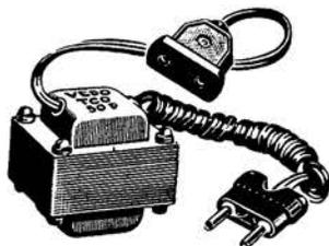
Ces auto-transfos de fabrication particulièrement soignée sont entièrement blindés. Alimentation sur réseau 220 V. par câble souple et fiche mâle. Sortie 110 V. par câble souple et prise femelle. Puissance 55 watts pouvant par intermittence être portée à 70 watts.
