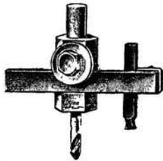
**Trépan professionnel**, pour cercles de 32 à 165  $\frac{m}{m}$ . Largement conçu, très robuste, il est destiné aux travaux d'atelier. Une mèche hélicoïdale exécute le trou central et sert de pivot guide pour l'exécution de l'ajour.
