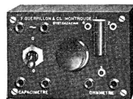
**Adaptateur type C.R.** Dispositif se plaçant sur le contrôleur 13 K par l'intermédiaire de trois broches, et transformant l'appareil en ohmmètre et en capacimètre. **Ohmmètre** à 3 sensibilités : 0,5 à 3.000 - 50 à 30.000 ohms - 500 ohms à 3 mégohms. **Capacimètre** à 2 sensibilités : 2.000 pf à 1 Mfd - 0,2 à 20 Mfd. Présentation : boîtier bakélite moulée. Dimensions : 100×70×55 mm .....
