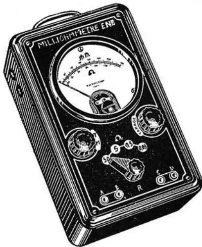
On sait que la mesure des faibles résistances par les méthodes habituelles est limitée par les erreurs dues à la résistance des différents contacts du circuit ainsi qu'à celle des connexions dont la valeur ne peut plus être négligée devant la résistance à mesurer.
