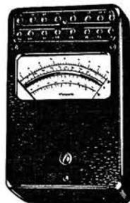
Contrôleur de poche à 10 000 Ω par volt. Appareil à 28 calibres de construction robuste ; intérieur isolant moulé, extérieur métallique incassable, à angles arrondis, sans aucune partie saillante.
