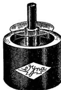
Les perforateurs comprennent : un poinçon, une matrice, un extracteur guide. Ils sont en acier fondu, trempé, revenu et rectifié. On peut découper de la tôle ou de l'aluminium jusqu'à 15/10 de millimètre d'épaisseur. L'ensemble est siférisé noir, l'extracteur zingué.
