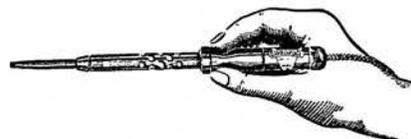
**Type Stylo.** — Modèle miniature 35 watts spécialement établi pour les soudures délicates. Diamètre du corps du fer 12 mm. Poids 65 gr. Livré avec panne droite vissée Ø 6 mm, pour secteur 120/130 ou 220 V (à préciser) ..... ★ + 1 185
