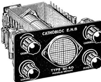
**Cathobloc type BC40.** — Ce bloc comporte un tube cathodique de 35 mm de diamètre avec tous ses organes de réglage : luminosité, finesse, cadrage horizontal et vertical.
