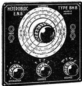
Ce bloc permet la réalisation facile d'une hétérodyne H.F. modulée permettant de couvrir, sans trou, toutes les fréquences comprises entre 100 KHz et 32 MHz (3.000 m. à 9,35 m.).
