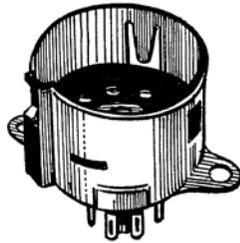
**RIMLOCK ou MEDIUM type 595.** Support pour nouvelles lampes de la série Rimlock. Ce support très bien étudié se compose d'un corps de bakélite moulée avec contacts à pinces recouverts d'une rondelle en bakélite moulée assurant un parfait centrage des broches, un contact excellent et un blocage absolu de la lampe . . 69
