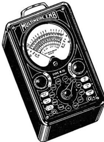
**Type M30.** — Contrôleur universel à 48 sensibilités, équipé d'un microampère-mètre à cadre mobile de grande précision et de 500  $\mu A$  de déviation totale, avec remise à zéro et aiguille à couteau (équipement grand modèle Da et Dutilh. Cadran de 100 mm de diamètre à 6 échelles en deux couleurs. Changement de sensibilités par commutateurs. Précision  $\pm 1\%$ . Comporte les sensibilités suivantes :
