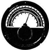
**Cadran type 4250.** Démultiplificateur livré en boîtier bakélite noire moulée, s'encastre dans un panneau comme un instrument de mesure (milli-voltmètre). Diamètre : 115 mm, profondeur intérieure : 35 mm.
