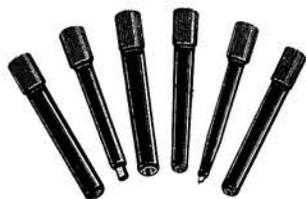
**Jeu de 6 clés en bakélite moulée** comprenant : 1 tournevis à padding, 1 clé mâle à 6 pans pour le réglage des noyaux magnétiques des bobinages, 2 clés femelles à 6 pans pour écrous de trimmers et une clé femelle à fente rectangulaire. Ce jeu de clés permet de régler tous les éléments ajustables d'un récepteur.
