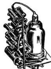
Oscillobloc type BB1. — Dérivé du type BB6, mais ne délivrant qu'une seule fréquence de 1.000 p/s ; convient pour alimenter le Pontobloc ou moduler l'Hétérobloc.
