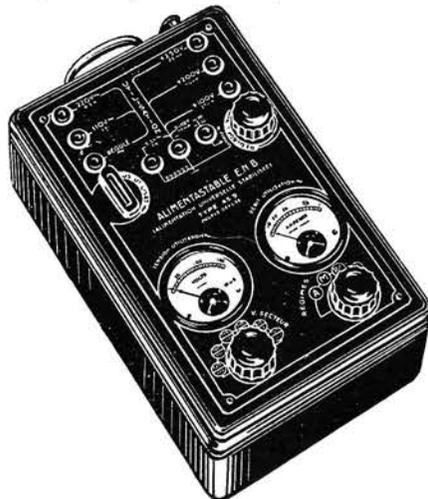
0 à 100 V (10 mA) en continu et alternatif, à réglage graduel par potentiomètre.
