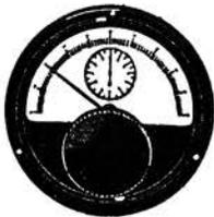
**Cadran Type 4252.** Ce modèle est identique comme forme au 4250 mais il est muni d'une aiguille trotteuse indiquant le 1/1000° sur des divisions de 1 mm; l'échelle de lecture possède donc une étendue de un mètre, soit 1.000 divisions de 1 mm.
