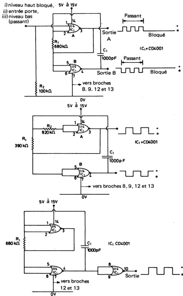
Fig. 2.13. Multivibrateur astable : a) déclenché; b) avec compensation; c) avec sortie tamponnée
