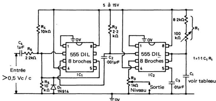
Fig. 2.33. Générateur d'impulsions amélioré, déclenché par signal d'entrée
