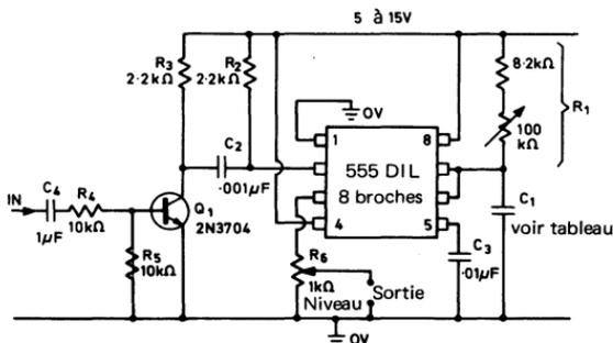
Fig. 2.32. Générateur d'impulsions déclenché par signaux rectangulaires; le signal de commande peut atteindre 100 kHz
