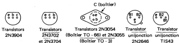
Fig. 7.4. Brochage des transistors
