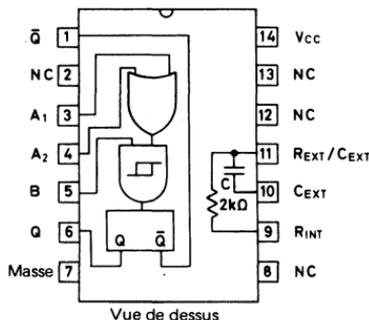
Fig. 2.35. Circuit intégré 74121 N brochage et architecture interne de ce multivibrateur monostable
