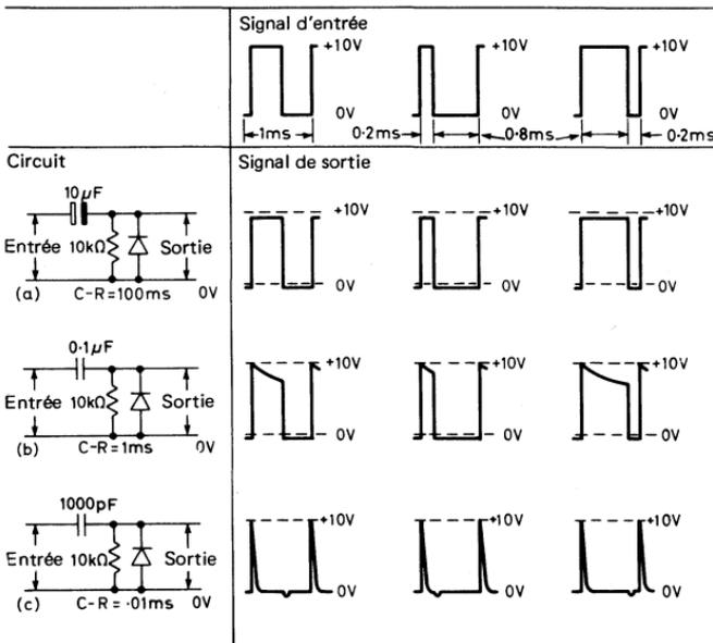
Fig. 5.2. Influence d'un circuit RC auquel on ajoute des diodes de clamping positif sur des signaux carrés symétriques ou non symétriques
