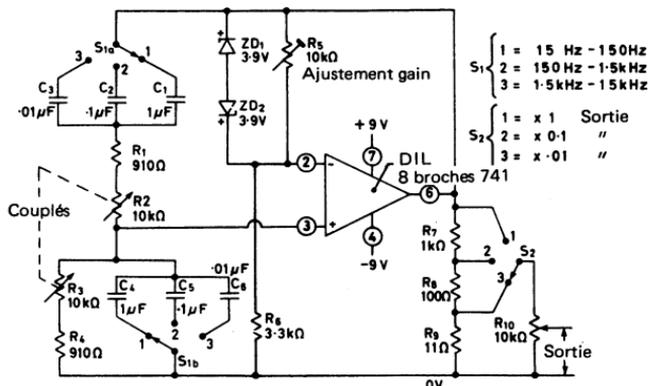
Fig. 1.9. Oscillateur à pont de Wien à 3 décades, 15 Hz - 15 kHz
