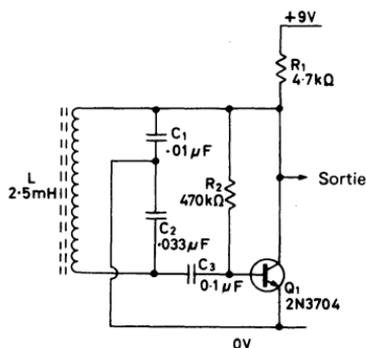
Fig. 1.11. Oscillateur Colpitts 37 kHz
