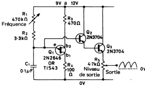
Fig. 3.1. Ce circuit simple à UJT délivre un signal en dent de scie non linéaire
