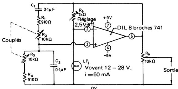
Fig. 1.5. Oscillateur à double T 150 Hz à 1 kHz
