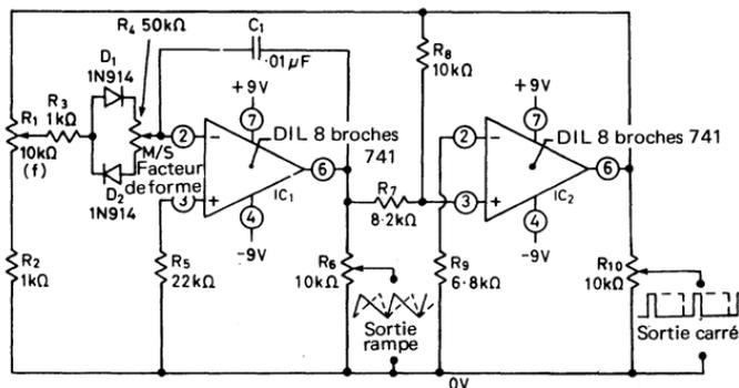
Fig. 4.5. Générateur de rampe et de signal carré 100 Hz à 1 kHz à pente et facteur de forme variable
