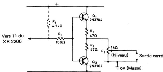
Fig. 4.7. Circuit auxiliaire permettant d'obtenir une sortie basse impédance, de niveau réglable sur le générateur de signal carré XR 2206
