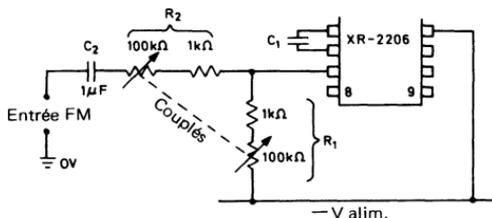
Fig. 6.7. Modulation de fréquence à excursion relative constante du circuit intégré XR2206
