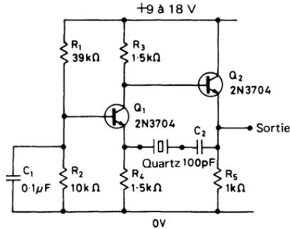
Fig. 5.7. Oscillateur à cristal 50 kHz – 10 MHz (suivant fréquence du quartz)
