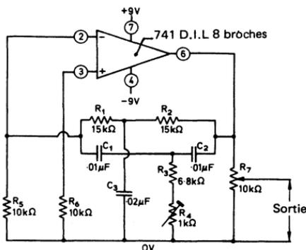
Fig. 1.3. Oscillateur 1 kHz à T ponté
