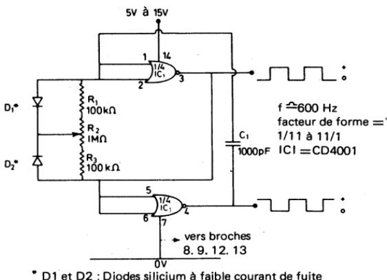
Fig. 2.14. Multivibrateur astable à facteur de forme variable
