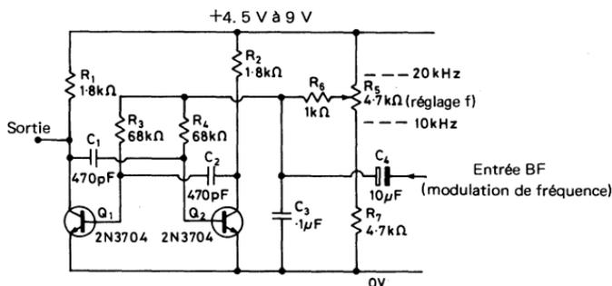
Fig. 6.4. Circuit astable à transistor à fréquence variable et à modulation de fréquence
