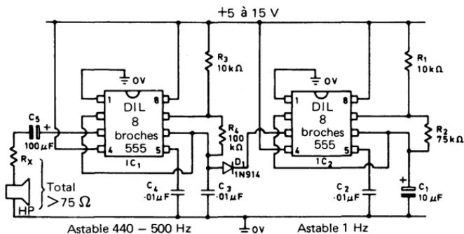
Fig. 5.21. Générateur de signal d'alarme pulsé, fréquence 800 Hz
