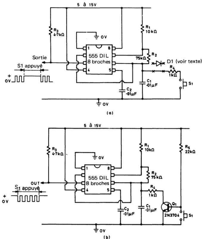
Fig. 2.20. Multivibrateur astable à 1 kHz
