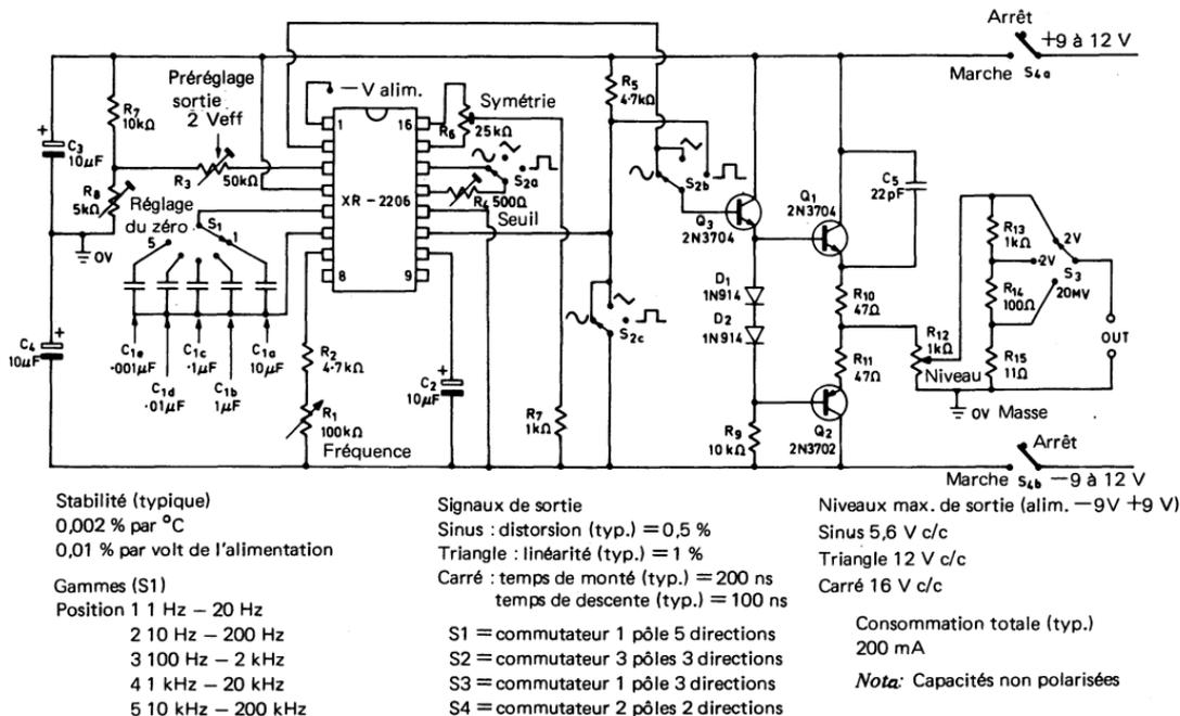
Fig. 4.8. Schéma et détails de réalisation d'un générateur économique et performant 1 Hz – 200 Hz sinus/triangle/carré
