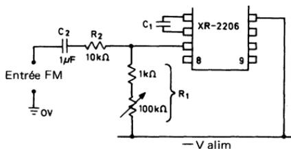
Fig. 6.6. Modulation en fréquence du XR2206
