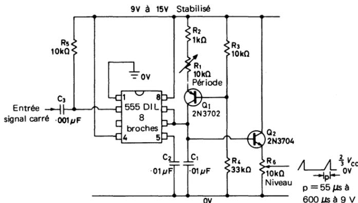
Fig. 3.8. Générateur de dent de scie linéaire à déclenchement utilisant un 555
