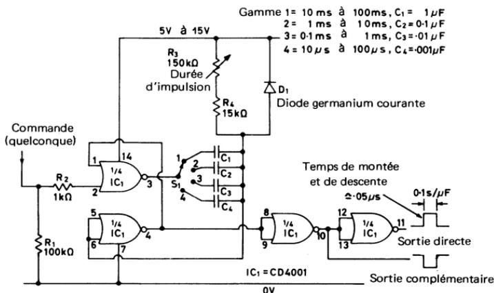
Fig. 2.26. Générateur d'impulsion économique à circuit intégré COS MOS, pour le laboratoire de l'amateur, gamme 10  $\mu$ s à 100 ms, à sorties complémentaires
