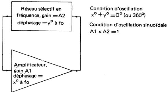
Fig. 1.1. Schéma de principe d'un oscillateur et conditions nécessaires à son fonctionnement.
