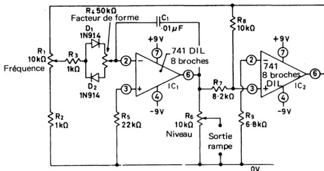
Fig. 3.6. Générateur de rampe à pente variable 100 Hz à 1 kHz
