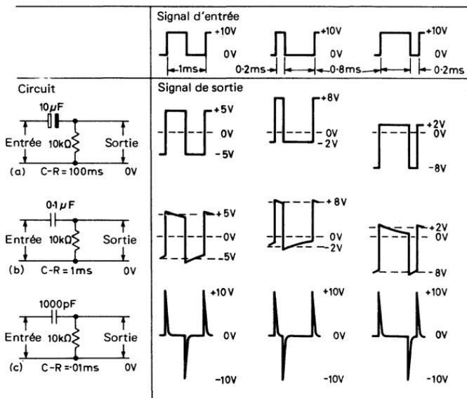
Fig. 5.1. Influence d'un circuit RC sur des signaux carrés symétriques et non symétriques
