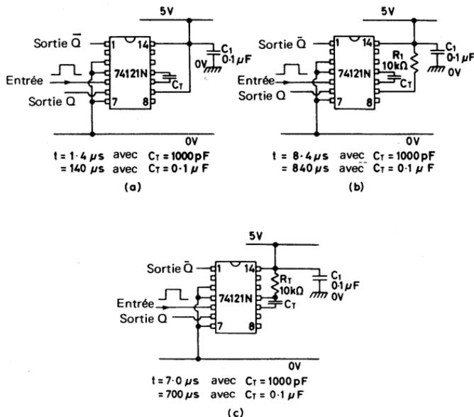
Fig. 2.37. Générateur d'impulsions utilisant une capacité extérieure et (a) une résistance interne ou (b) une résistance interne et une résistance externe ou (c) une résistance externe pour déterminer sa constante de temps
