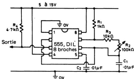
Fig. 2.16. Ce générateur de signal carré couvre la gamme 650 Hz à 7,2 kHz environ
