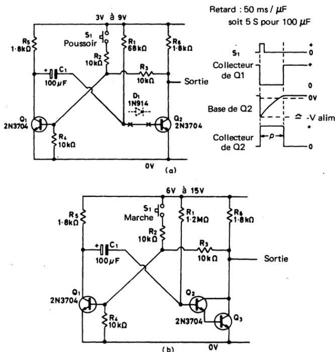
Fig. 2.21. Générateur d'impulsions à monostable (a) montage de base et forme des signaux; (b) version permettant d'obtenir des durées de l'ordre de 100 secondes
