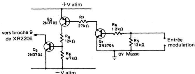
Fig. 6.10. Circuit translateur de tension permettant de référencer à la masse le signal de modulation FSK du circuit XR2206
