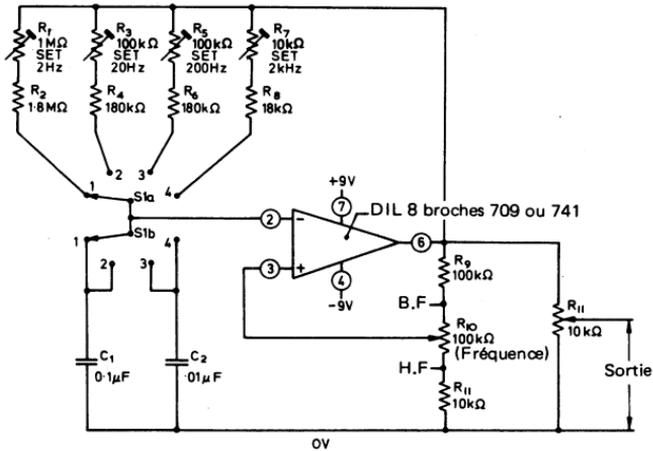
Fig. 2.10. Générateur de signal carré 4 décades 2 Hz à 20 kHz
