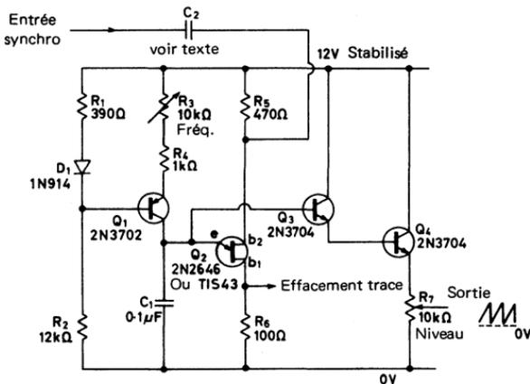
Fig. 3.2. Un générateur de dent de scie linéaire peut être utilisé comme base temps pour un oscilloscope
