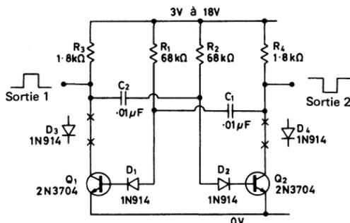
Fig. 2.4. Multivibrateur astable 1 kHz à correction de fréquence
