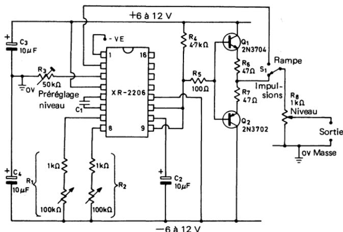
Fig. 4.9. Générateur d'impulsions et de rampes variables
