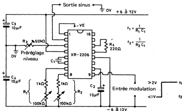
Fig. 6.9. Générateur à modulation FSK à double alimentation
