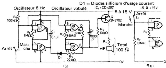
Fig. 5.14. Générateur de signal d'alarme vobulé; (a) à déclenchement par contact; (b) à déclenchement par coupure
