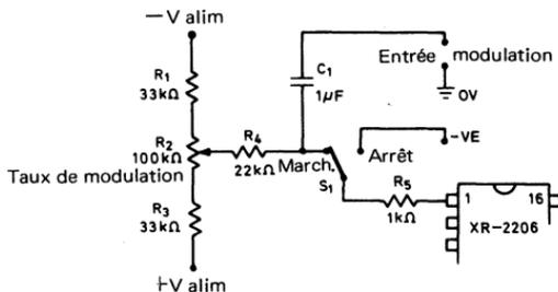
Fig. 6.2. Modulation d'amplitude de générateur sinus - triangle XR2206 vu précédemment
