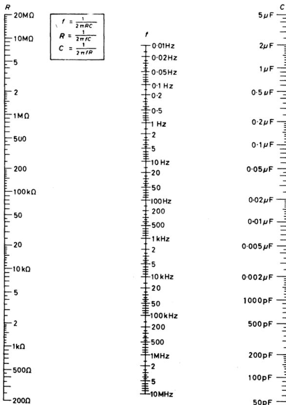
Fig. 8.2. Abaque de sélection des composants du double T symétrique ou du pont de Wien à utiliser avec 8.3. pour plus de précision
