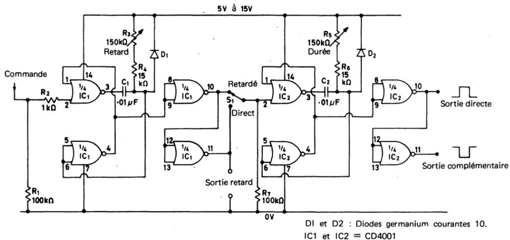
Fig. 2.27. Générateur d'impulsion économique pour le laboratoire de l'amatteur, avec retard, couvrant la gamme 0,1 ms à 1 ms
