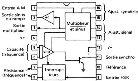
Fig. 7.1. Schéma fonctionnel et brochage (vu de dessus) du générateur de fonction intégré XR2206
