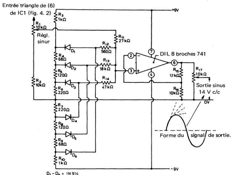
Fig. 4.4. Adaptateur sinus à utiliser avec le circuit de la figure 4.2
