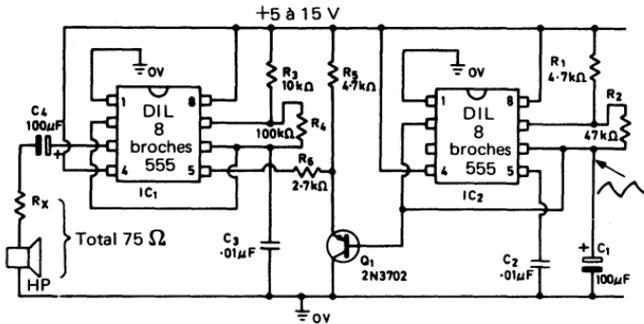
Fig. 5.23. Générateur de signal d'alarme simulant la sirène des voitures de police américaines
