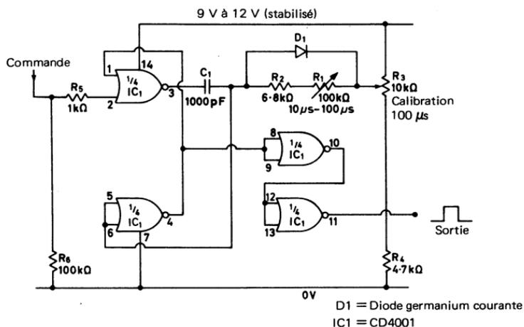
Fig. 2.28. Multivibrateur monostable « calibrable », gamme  $10 \mu\text{s}$  à  $100 \mu\text{s}$ , ses performances peuvent être rendues indépendantes des caractéristiques du CD4001
