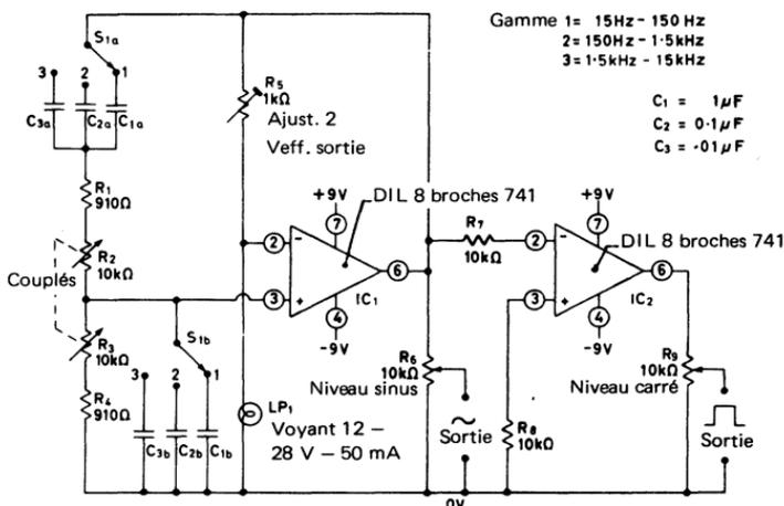
Fig. 4.1. Générateur de signal sinus/carré 15 Hz - 15 kHz à ampli opérationnel
