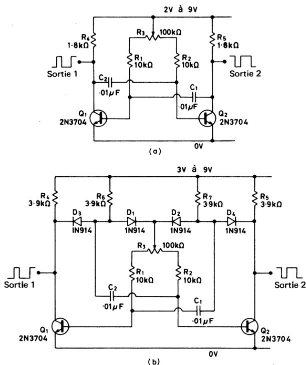
Fig. 2.8. — Multivibrateur astable à facteur de forme variable fonctionnant à environ 1100 Hz
