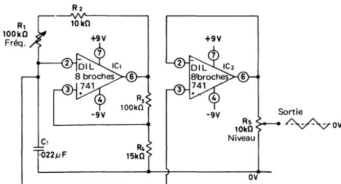
Fig. 3.3. Générateur de triangle 800 Hz – 8 kHz à ampli opérationnel
