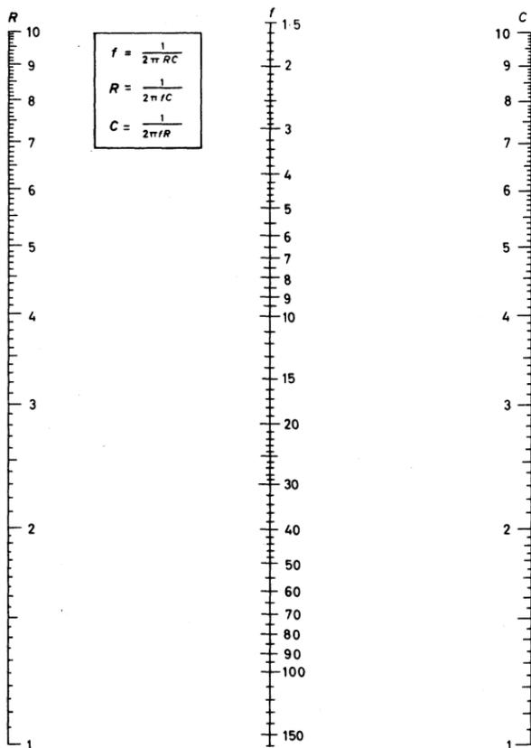
Fig. 8.3. Abaque de sélection des composants du double T symétrique ou du pont de Wien avec échelle agrandie, à utiliser avec 8.2.; les valeurs peuvent être multipliées ou divisées par  $10^P$
