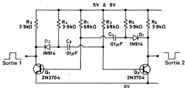
Fig. 2.6. Multivibrateur astable 1 kHz avec correction du signal
