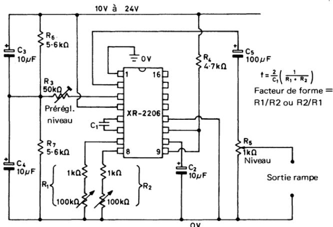
Fig. 3.12. Générateur de rampe à pente variable XR 2206 à alimentation simple
