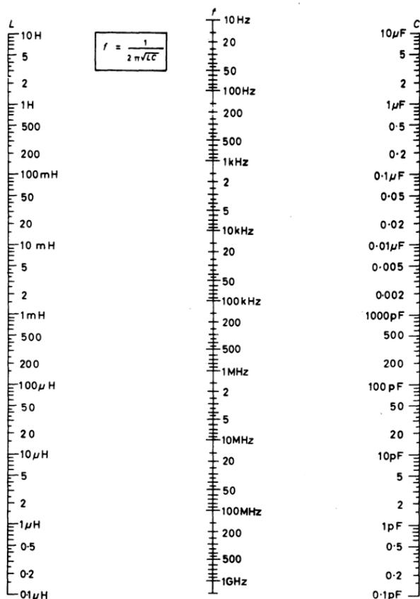
Fig. 8.4. Abaque de choix des composants d'un circuit LC, à utiliser avec 8.5. pour plus de précision
