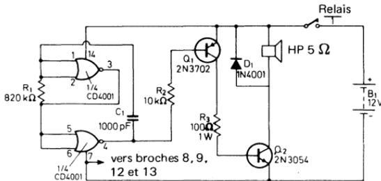
Fig. 5.18. Générateur de signal d'alarme à un seul ton, puissance 10 W
