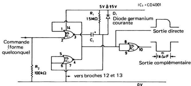
Fig. 2.25. Monostable COS MOS avec temps de commutation réduit et sorties complémentaires
