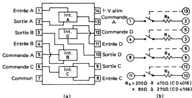
Fig. 6.12. Quadruple interrupteur réversible CD 4016 et CD 4066 :
