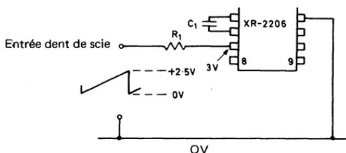
Fig. 6.5. Circuit pour moduler en rampe linéaire la fréquence du XR2206 avec un rapport  $f_2/f_1 = 6$
