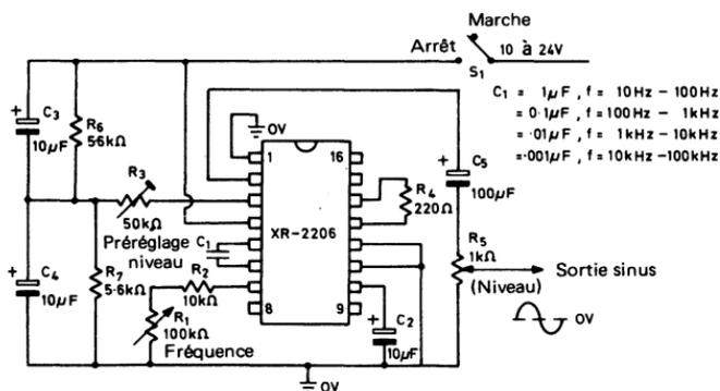
Fig. 1.14. Générateur sinusoïdal à une seule alimentation à circuit intégré
