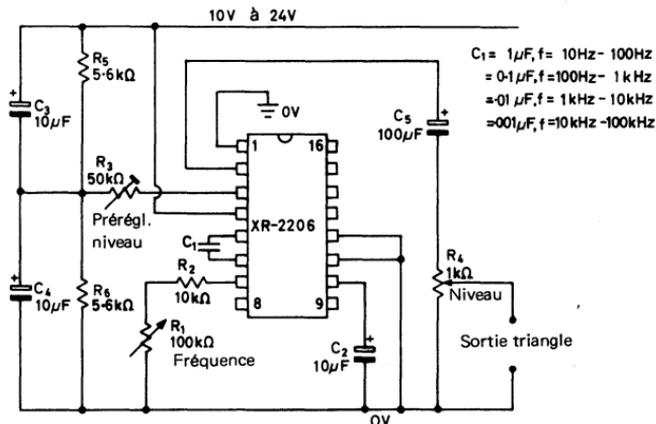
Fig. 3.10. Générateur de signal triangle XR 2206 à alimentation simple
