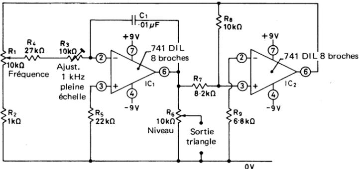
Fig. 3.5. Générateur de triangle linéaire 100 Hz – 1 kHz
