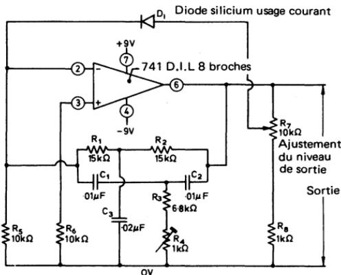
Fig. 1.4. Oscillateur 1 kHz à T ponté, réglé par diode
