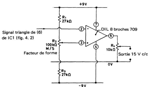
Fig. 4.3. Adaptateur à facteur de forme variable à utiliser avec le circuit 4.2.
