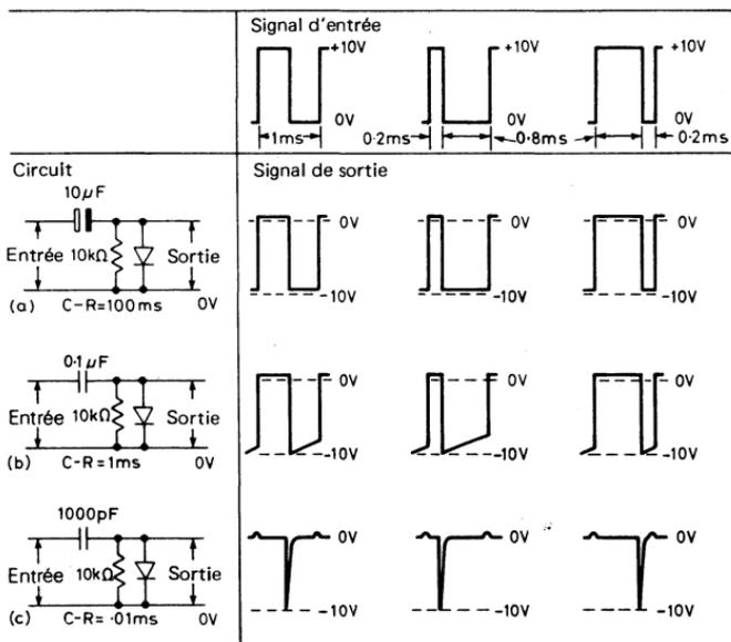
Fig. 5.3. Influence d'un circuit RC auquel on ajoute des diodes de clamping négatif sur des signaux carrés symétriques et non symétriques
