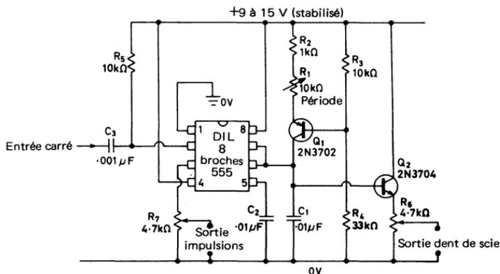
Fig. 4.15. Générateur d'impulsions et de dent de scie  $55 \mu\text{s} - 600 \mu\text{s}$  déclenché
