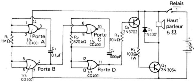
Fig. 5.19. Générateur de signal d'alarme 10 W pulsé
