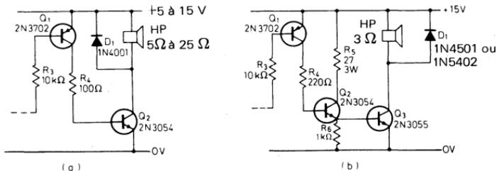
Fig. 5.17. Les niveaux de sortie des circuits 5.13 à 5.16 peuvent être accrus en utilisant (a) un amplificateur moyenne puissance (0,25 – 11,25 W); (b) un amplificateur de forte puissance (18 W)
