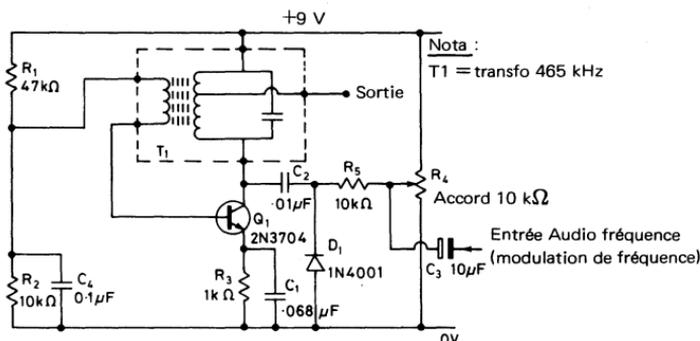
Fig. 6.3. BFO 465 kHz avec accord par varicap et modulation de fréquence
