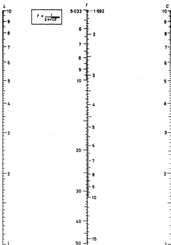
Fig. 8.5. Abaque de choix des composants d'un circuit LC, à utiliser avec 8.4. Les valeurs peuvent être multipliées ou divisées par  $10^p$
