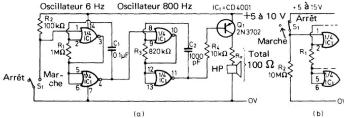
Fig. 5.13. Générateur d'alarme à tonalité pulsée; (a) à déclenchement par fermeture; (b) à déclenchement par coupure
