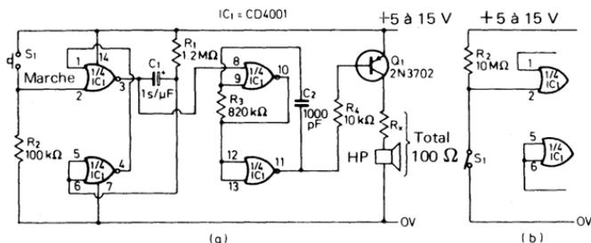
Fig. 5.15. Générateur de signal d'alarme à durée de fonctionnement limitée
