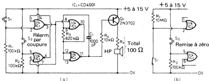
Fig. 5.16. Générateur de signal d'alarme à verrouillage – fréquence 800 Hz
