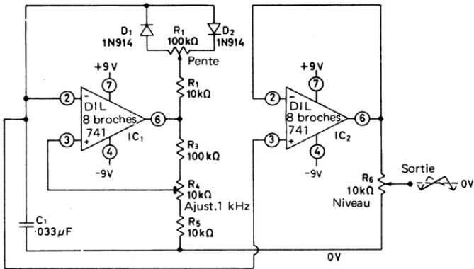
Fig. 3.4. Générateur de rampe à pente variable 1 kHz, à ampli opérationnel
