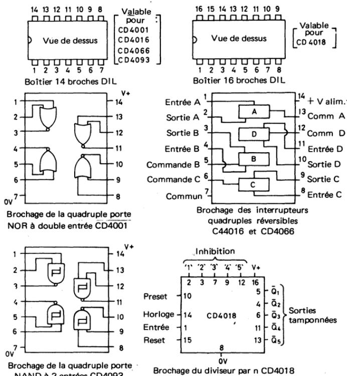
Fig. 7.3 Brochage et connexions (vus de dessus) des circuits intégrés COS MOS
