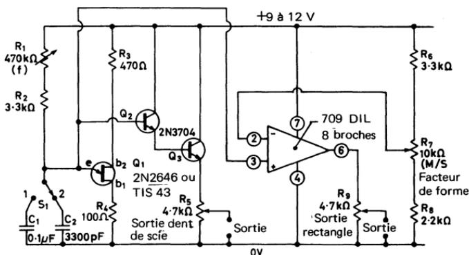
Fig. 4.14. Générateur dent de scie/carré 25 Hz – 100 kHz
