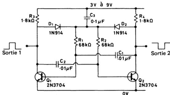
Fig. 2.7. Multivibrateur astable à 1 kHz avec sécurité de départ
