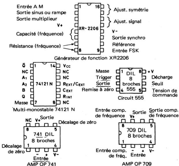
Fig. 7.2. Brochage et connexions (vus de dessus) des circuits intégrés autres que COS MOS
