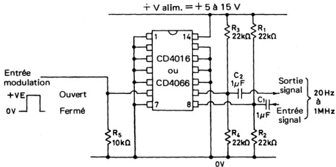
Fig. 6.14. Modulateur à coupure de porteuse à une seule alimentation
