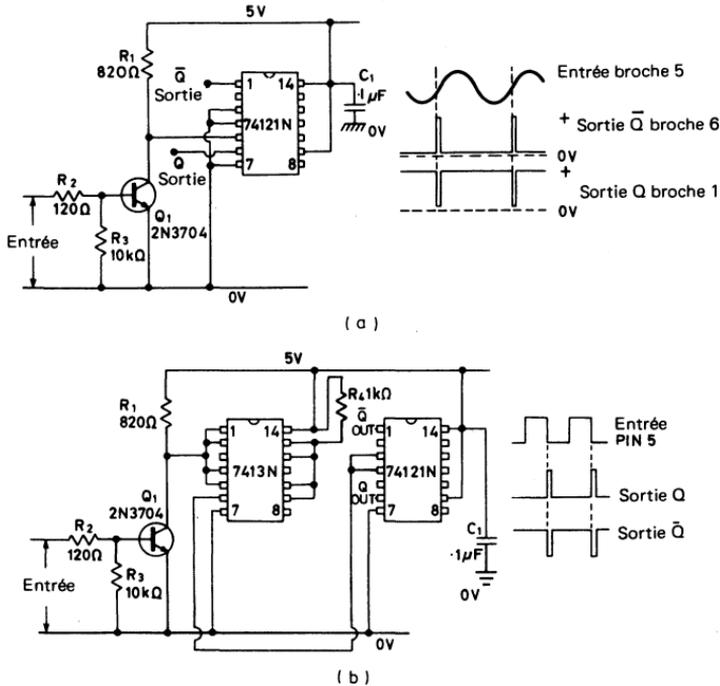
Fig. 2.36. Générateur d'impulsions 30 ns. (a) commande sur fronts montants, entrée B; (b) commande sur fronts descendants, entrée A1 et A2
