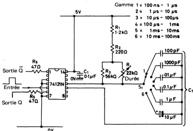
Fig. 2.38. Générateur d'impulsions performant couvrant la gamme 100 ns – 100 ms
