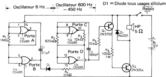
Fig. 5.20. Générateur de signal d'alarme à deux tons
