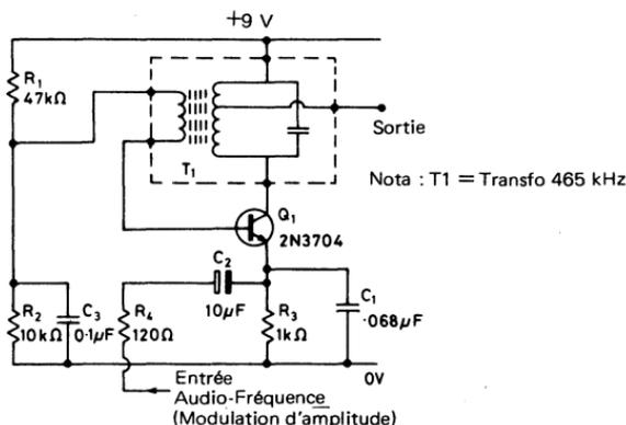
Fig. 6.1. BFO 465 kHz à modulation d'amplitude
