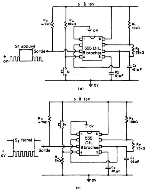
Fig. 2.19. Multivibrateur astable 1 kHz; (a) à coupure; (b) à ouverture
