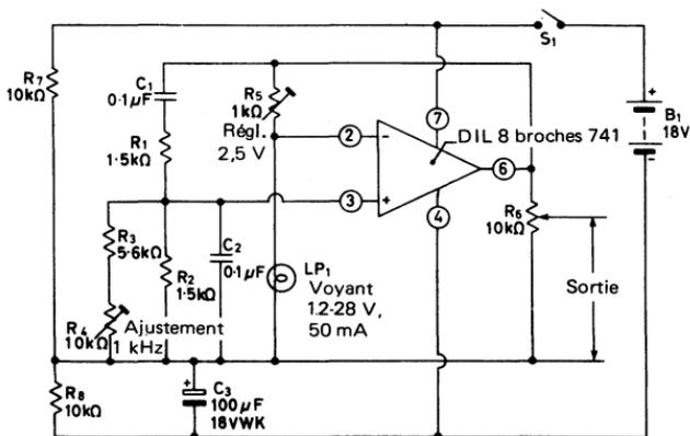
Fig. 1.8. Oscillateur à pont de Wien, monoalimentation, 1 kHz
