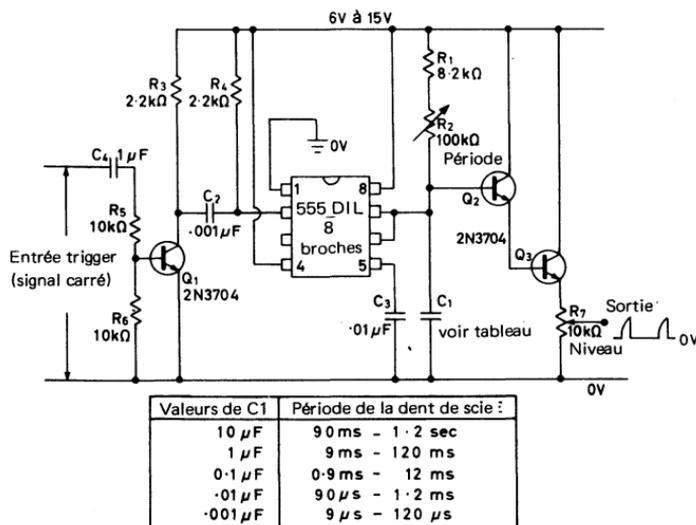
Fig. 3.7. Générateur de dent de scie utilisant un circuit 555 (montage de base)
