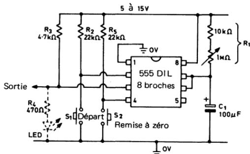
Fig. 2.31. Générateur d'impulsions à 555, déclenché manuellement, 1,1 à 110 s, avec remise à zéro
