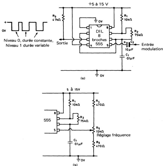
Fig. 6.8. Modulation en fréquence ou en position du circuit 555 utilisé en astable
