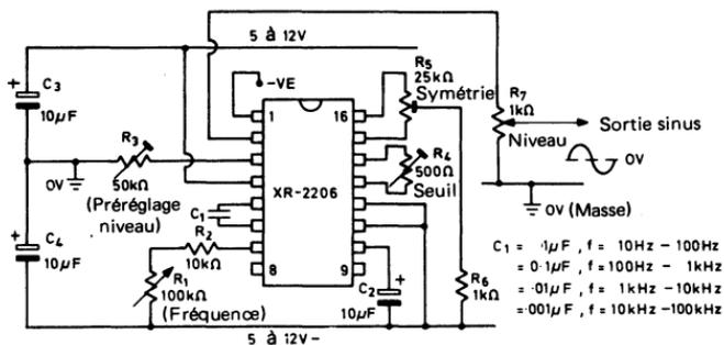
Fig. 1.15. Générateur sinusoïdal de qualité à circuit intégré et alimentation double
