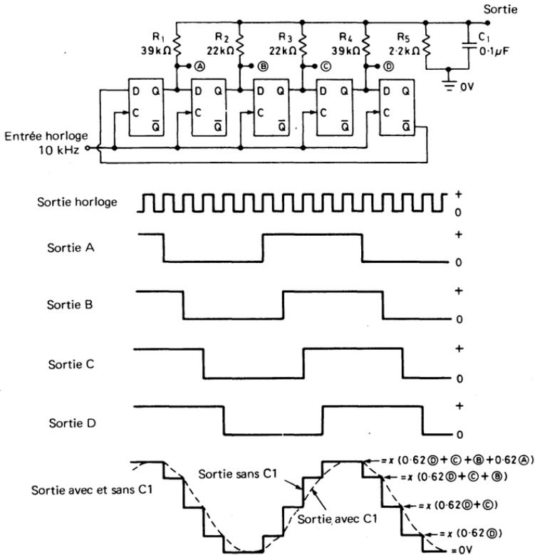
Fig. 5.10. Circuit de base et forme de signal du synthétiseur digital de signal sinusoïdal
