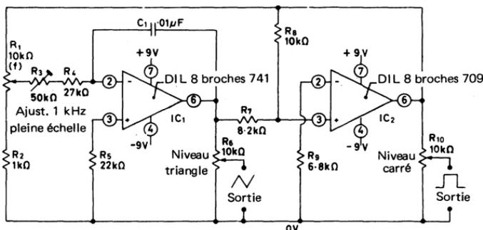
Fig. 4.2. Générateur de signal triangle/carré 100 Hz - 1 kHz à ampli opérationnel
