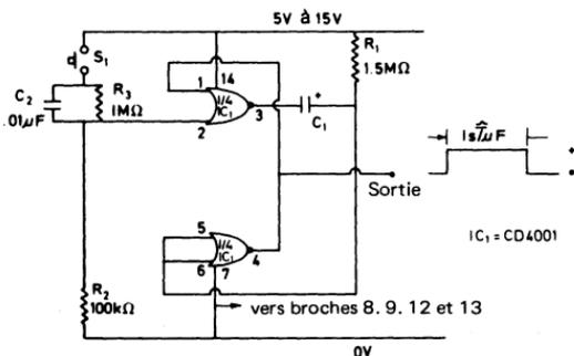
Fig. 2.23. Multivibrateur monostable – ou générateur d'impulsions à circuit intégré COS MOS
