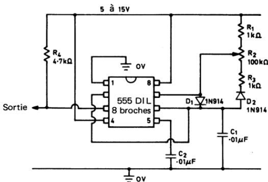
Fig. 2.18. Multivibrateur astable à facteur de forme variable de 1 à 99 %, la fréquence de fonctionnement étant égale à 1,2 kHz
