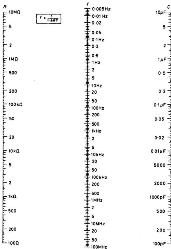
Fig. 8.6. Abaque de choix des composants pour les multivibrateurs astables à transistor
