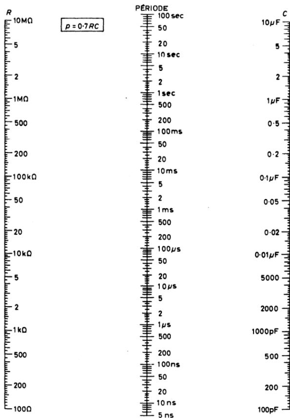
Fig. 8.7. Abaque de choix des composants pour les multivibrateurs mono-stables à transistor
