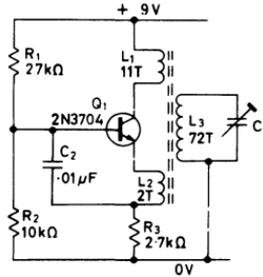
Fig. 1.12. Oscillateur 80 kHz Clapp-Gouriet      Fig. 1.13. Oscillateur Reinartz
