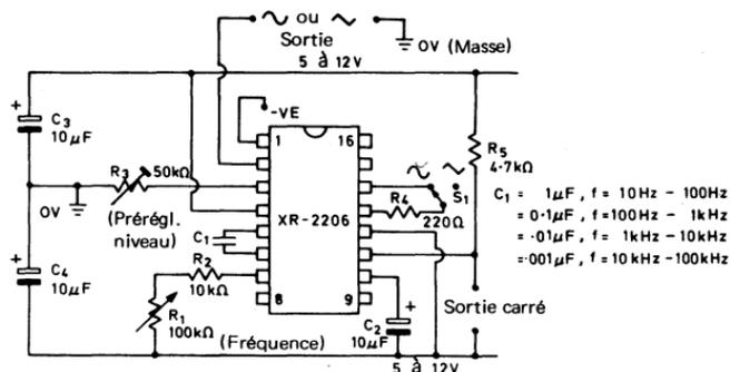
Fig. 4.6 Générateur simple sinus / triangle / carré à amplitude de sortie fixe.
