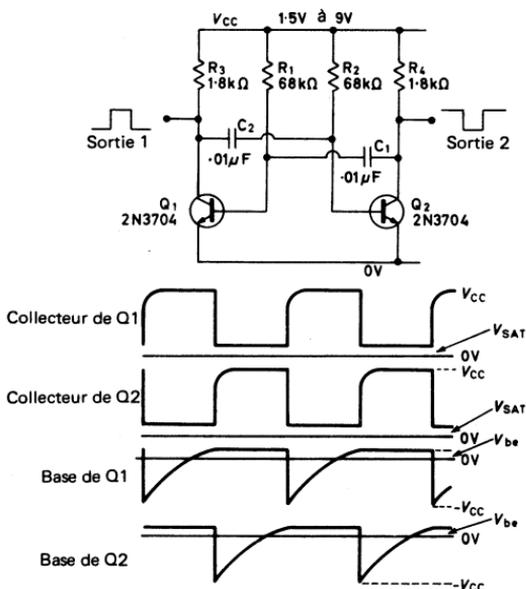
Fig. 2.3. Circuit et formes des signaux du multivibrateur astable 1 kHz
