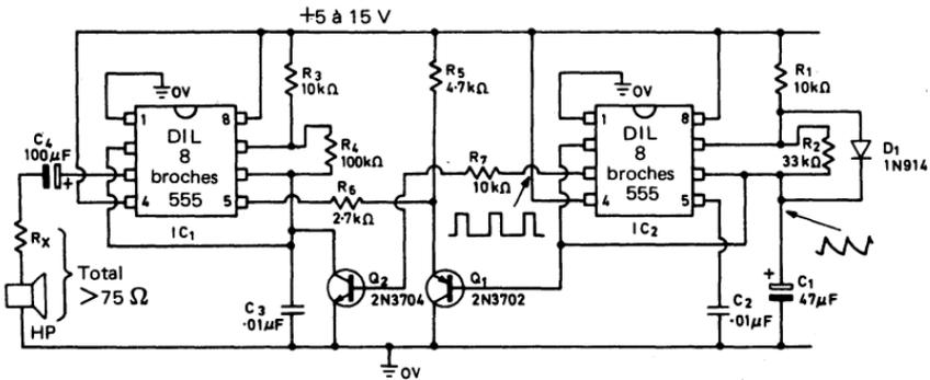
Fig. 5.24. Sirène à signal vobulé de style « science fiction »
