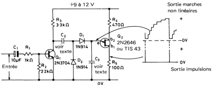
Fig. 5.9. Générateur non linéaire de marches, encore appelé pompe à diode
