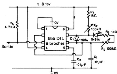
Fig. 2.17. Multivibrateur astable avec facteur de forme variable, les niveaux haut et bas étant réglables indépendamment de  $7,5 \mu s$   $750 \mu s$
