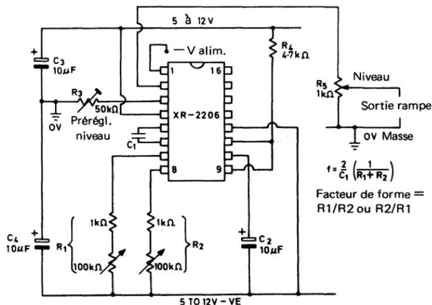
Fig. 3.11. Générateur de rampe à pente variable XR 2206 à alimentation double
