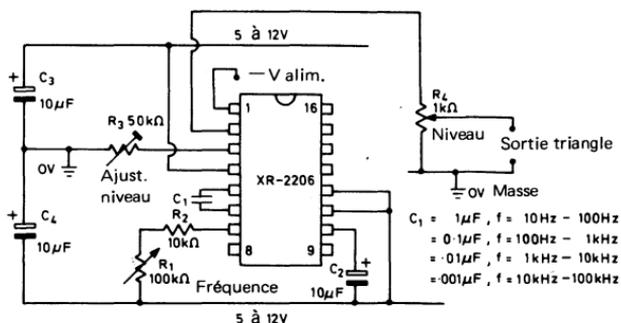
Fig. 3.9. Générateur de signal triangle à alimentation double XR 2206
