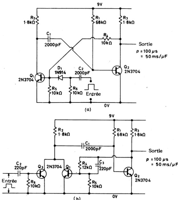
Fig. 2.22. Multivibrateur à monostable (a) déclenché électroniquement; (b) avec porte de déclenchement en entrée
