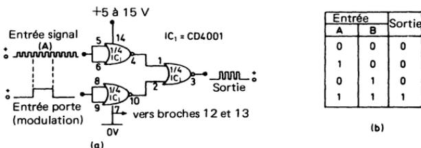
Fig. 6.11. Modulation par tout ou rien au moyen d'une porte (suppression de porteuse) (a) circuit; (b) table de vérité
