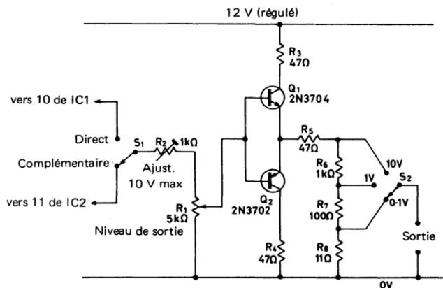
Fig. 2.30. Étage de sortie basse impédance et niveau variable pour 2.29
