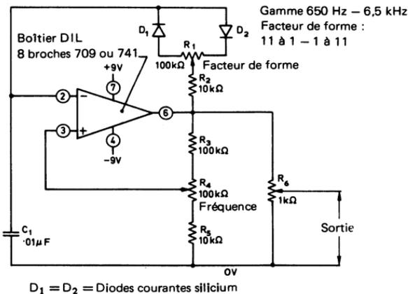
Fig. 2.11. Générateur de signal carré à fréquence et facteur de forme variables
