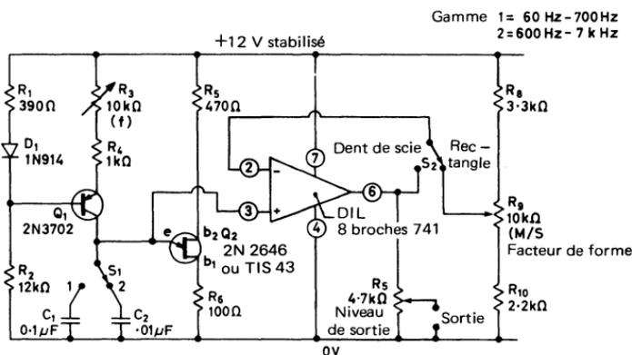
Fig. 4.13. Ce générateur à UJT 60 Hz - 7 kHz délivre de la dent de scie ou du signal carré à facteur de forme variable.
