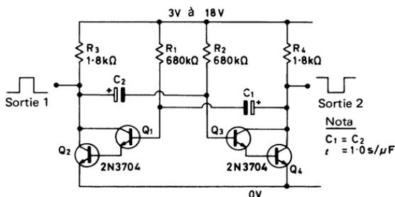
Fig. 2.5. Multivibrateur astable à transistor à longue période
