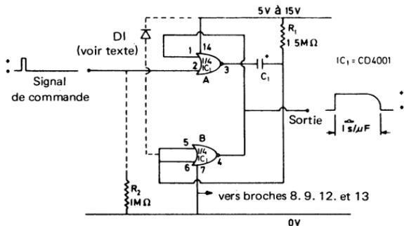
Fig. 2.24. Générateur d'impulsions monostable à circuit COS MOS déclenché manuellement
