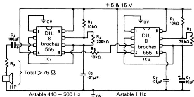
Fig. 5.22. Sirène de police à 2 tons
