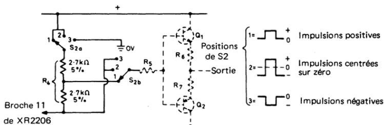
Fig. 4.10. Etage de sortie modifié permettant d'obtenir du circuit 4.9 des signaux positifs, négatifs ou symétriques par rapport à zéro
