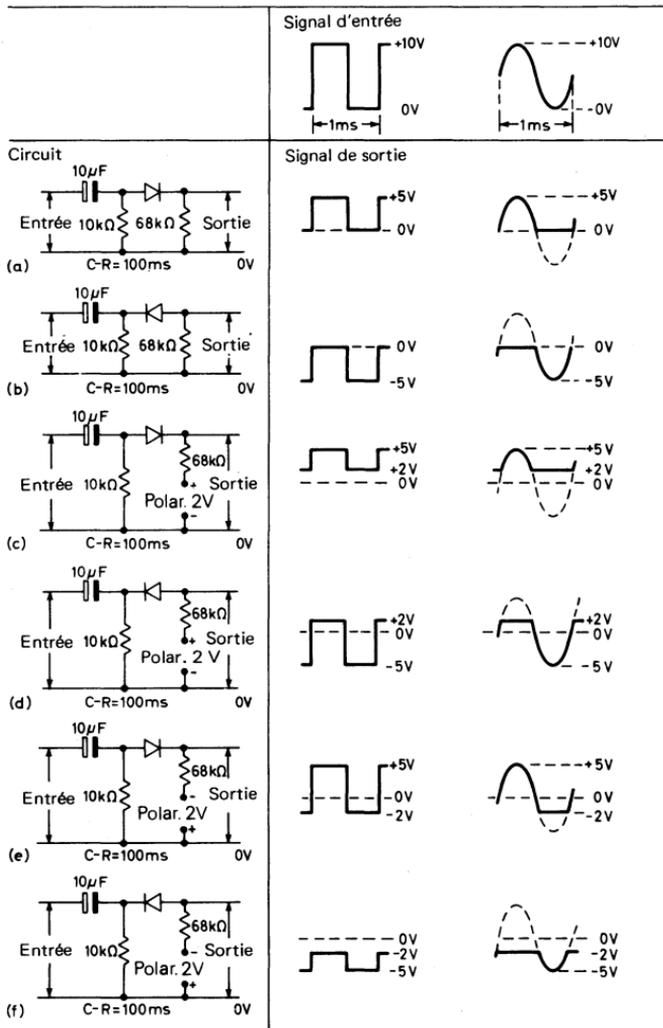
Fig. 5.5. Influence d'un circuit RC à grande constante de temps auquel on ajoute des diodes séries en sortie sur des signaux symétriques sinu: et carrés
