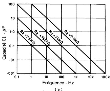
Fig. 2.15. a) Multivibrateur astable 1 kHz avec formules de définition de ses différents paramètres; b) relation approchée entre  $C_1$ ,  $R_2$  et la fréquence, lorsque  $R \ll R_1$ .
