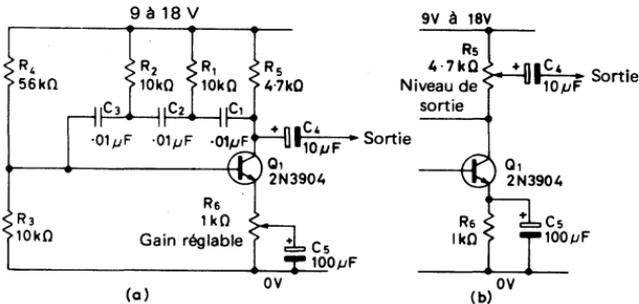
Fig. 1.2. Oscillateur 800 Hz à déphasage
