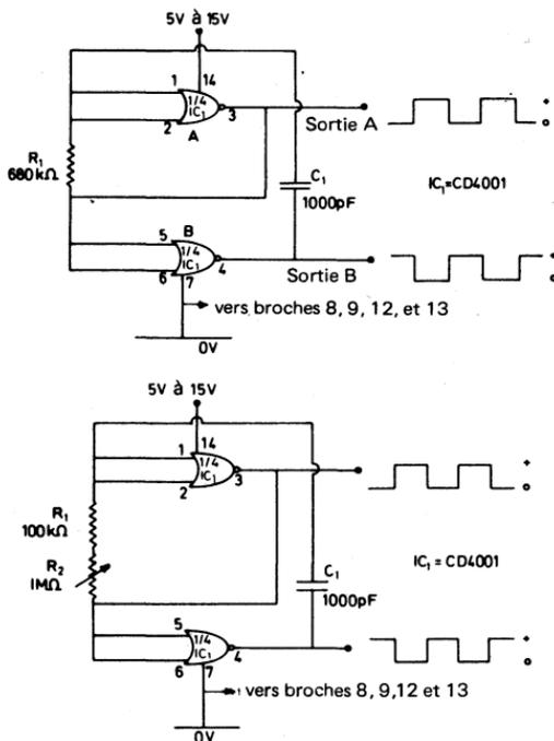
Fig. 2.12. Multivibrateur astable à circuit intégré COS MOS
