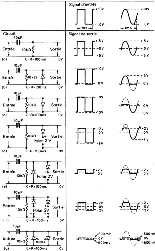
Fig. 5.4. Influence d'un circuit RC à grande constante de temps auquel on ajoute des diodes de clamping et/ou d'écrêtage sur les signaux symétriques sinus et carrés.
