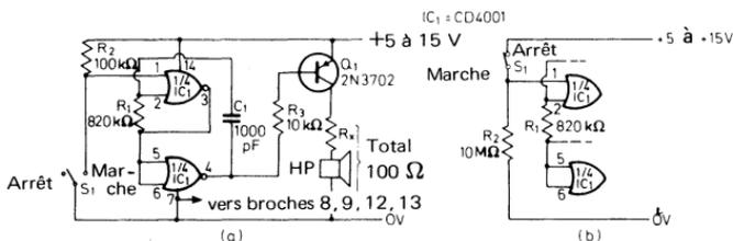
Fig. 5.12. Générateur de signal d'alarme 800 Hz; (a) à déclenchement par contact; (b) à déclenchement par coupure
