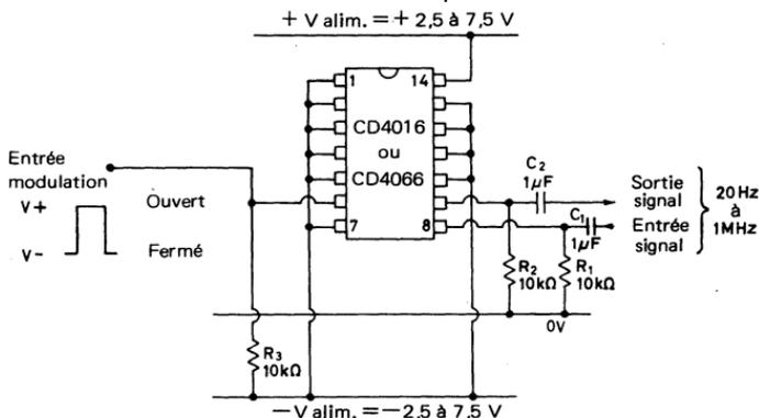
Fig. 6.13. Modulateur à coupure de porteuse à alimentation double
