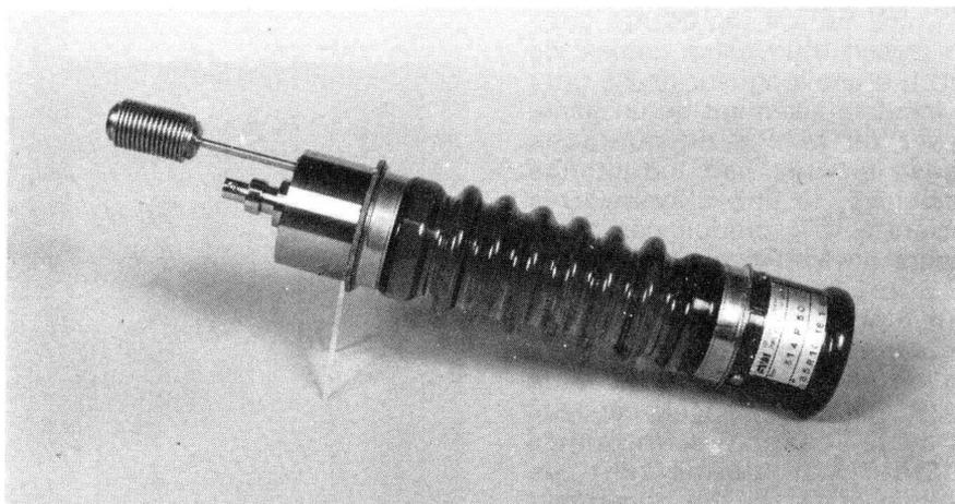
Charge de mesure haute tension.
