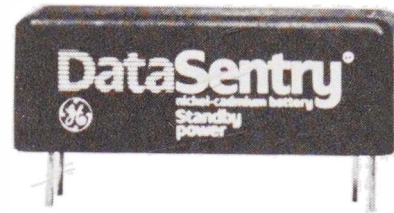
Pile de 2,4 V (70 mAh) montable sur circuit imprimé. (b) Courtoisie de General Electric Co.
