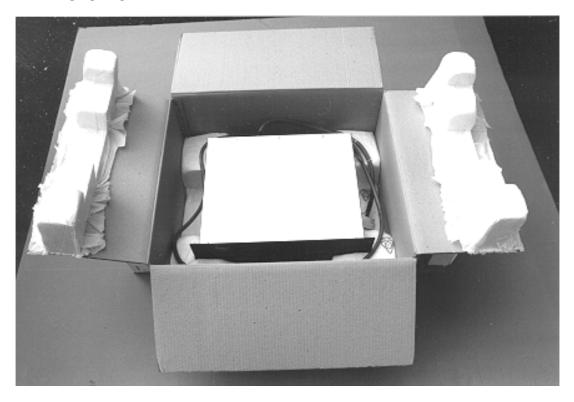
Le câble SCSI est enroulé autour du coffret et doit être replacé dans cette position lors de l'opération d'emballage (voir § 5.2.2).
