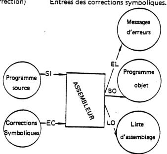
Avant d'activer l'assembleur, l'utilisateur peut associer à chaque unité symbolique une unité fonctionnelle (ou un fichier disque sous les systèmes d'exploitation disque) dont il dispose dans sa configuration.
