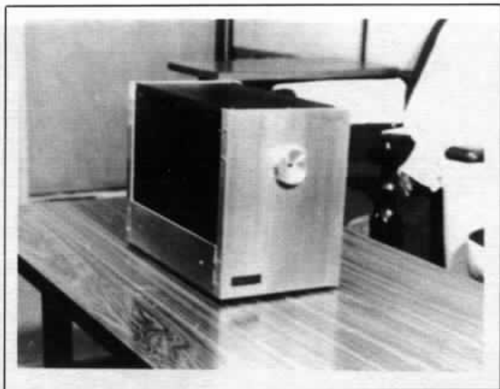
Fig. 13 - Tweeter ionique Réalon. C'est le premier sans pavillon et de haut rendement.
