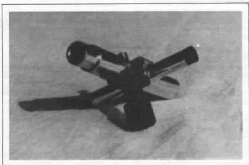
L'élément central avec le dispositif de compensation latérale réglable par la molette située à l'extrême droite du tube transversal.
