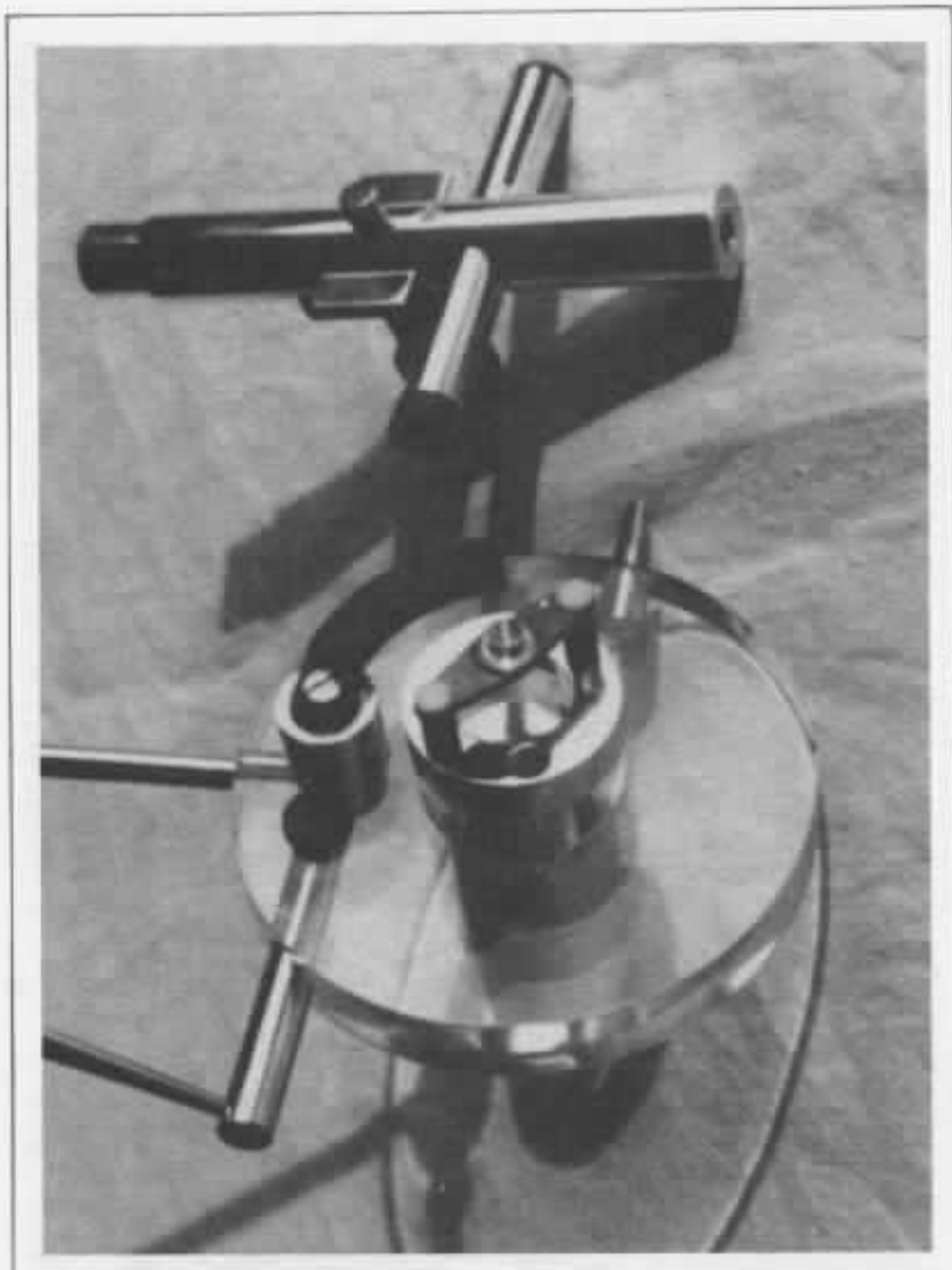
Vue du pilier, on remarquera la petite coupelle de l'unipivot, les butées de déséquilibre latéral et l'orifice de remplissage de fluide amortisseur.
