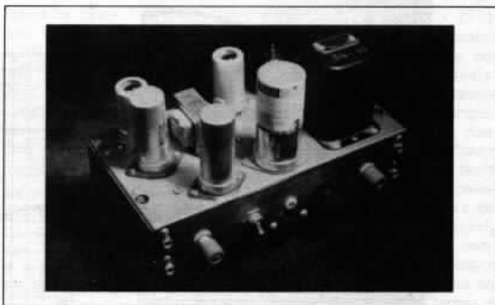
La réalisation originale. On remarquera que le transformateur de l'alimentation est blindé, ainsi que les tubes V1 et V2. La grosse capacité électrolytique est en fait une combinaison avec une inductance constituant la section filtrage en pi. Les autres capacités électrolytiques de plus petites dimensions sont également des modèles de ce type utilisées dans les découplages de plaques. Les tubes V3 et V4 ne sont pas blindés le tube V4 est en partie caché sur la photo. Photo R. G. Stillwell.
