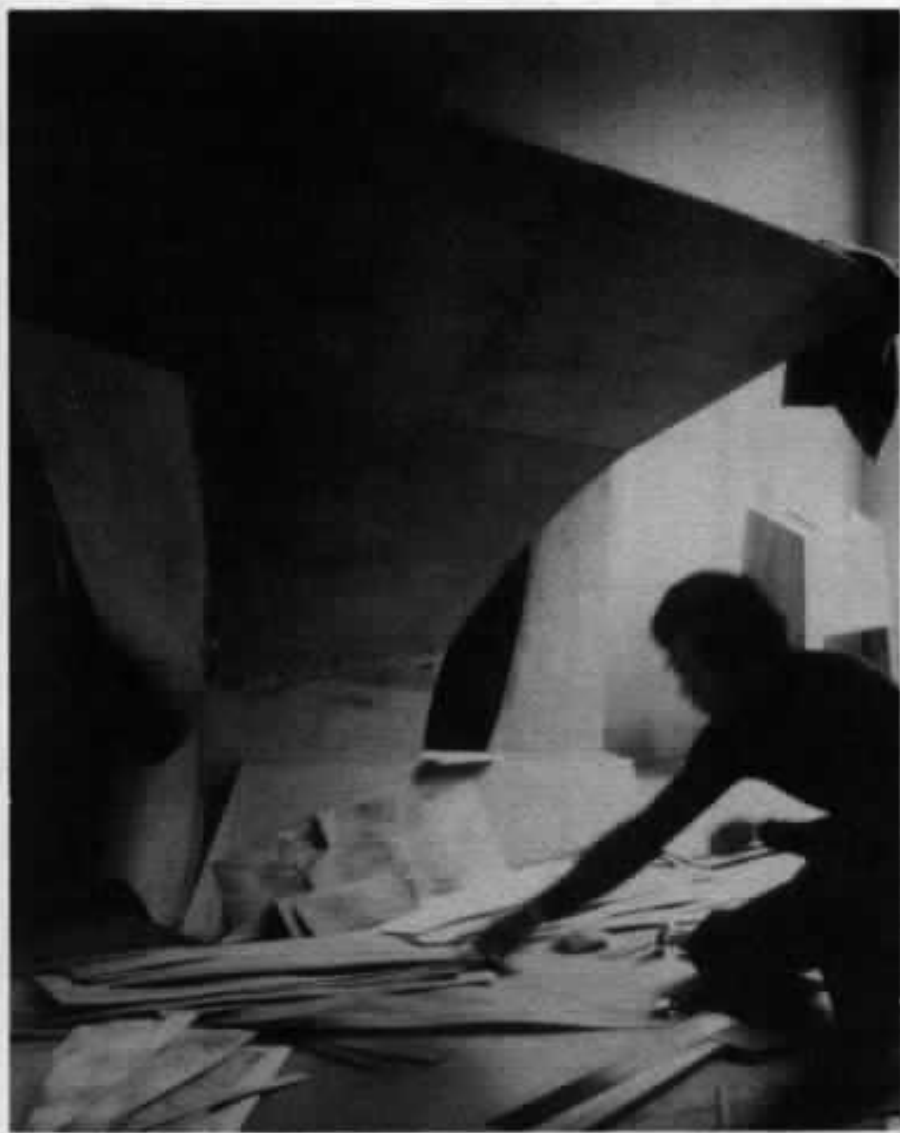
La fin des travaux approche. Découpage du merisier pour le placage
