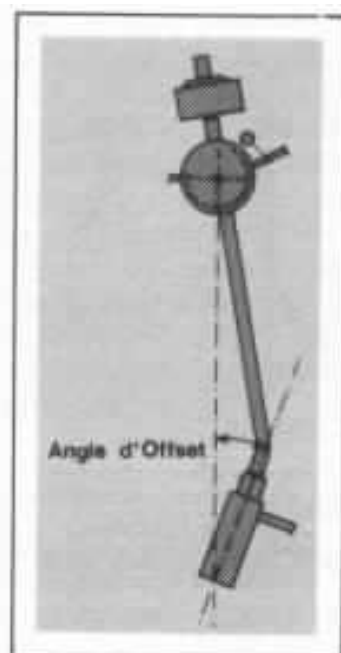
Fig. 8 : L'angle d'offset dans un bras pivotant
