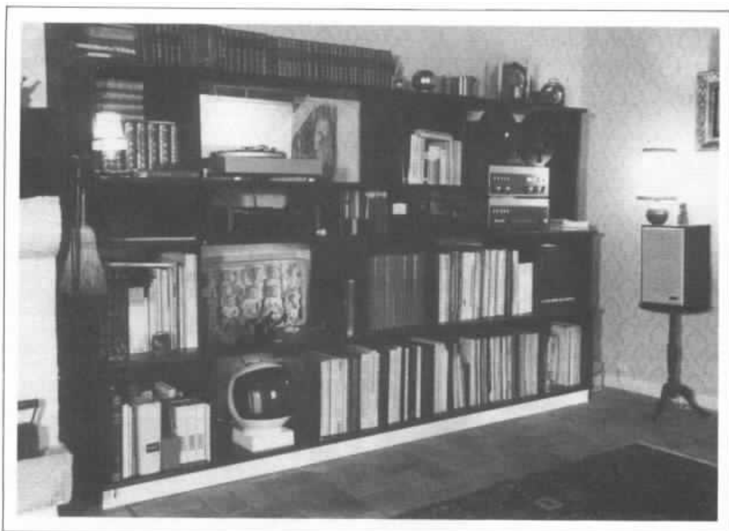
Fig 6 - Meuble technique ou bibliothèque - Ensemble modulable à volonté, outre la facilité de mise en œuvre et le faible coût, ce meuble peut être composé et dessiné en fonction de l'encombrement de chacun des éléments de la chaîne. D'autre part il forme un ensemble de cases dans lesquelles le son est « piégé » ce qui traite cette face du parallélépipède.
