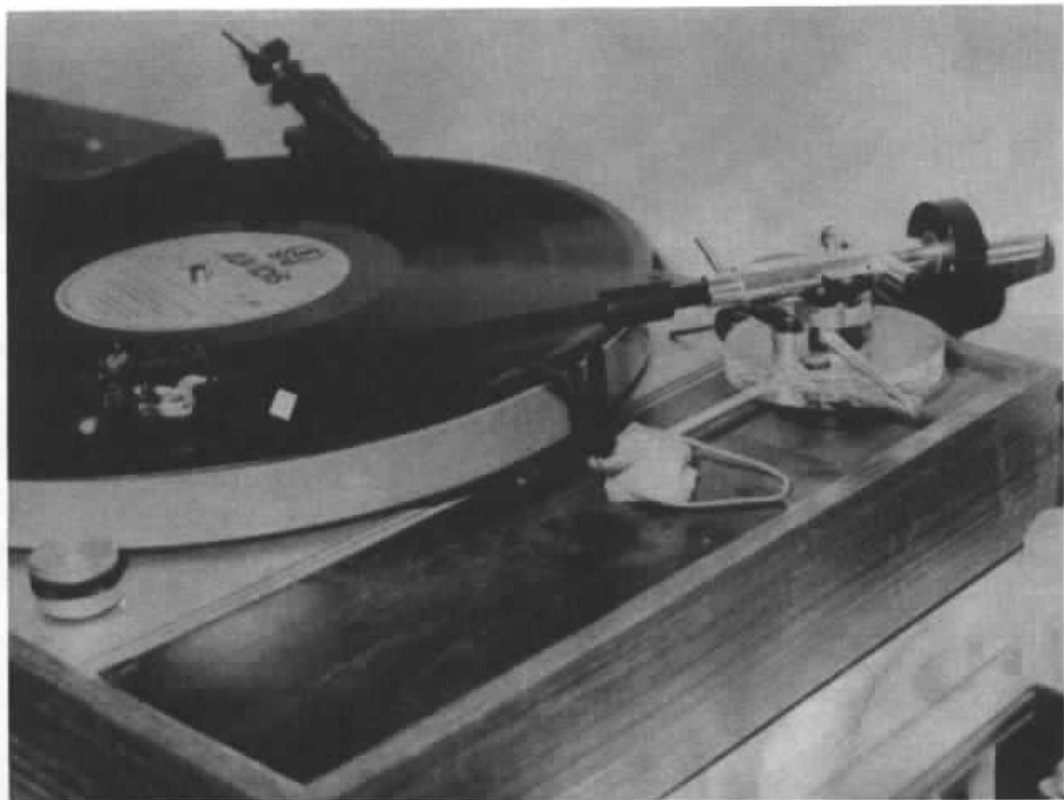
La platine TD 150 équipée du bras Lurné et d'une cellule Shure V15IV. Force d'appui 1,25 g sans antiskating. Fréquence de résonance de l'ensemble bras-cellule tant en vertical qu'en horizontal : 12 Hz.
