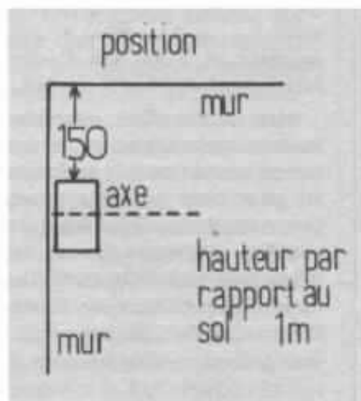
Fig 3 : L'enceinte est surélevée par rapport au sol, écartée du mur latéral et légèrement séparée du mur du fond. La dépression observée dans le cas antérieur est compensée.
