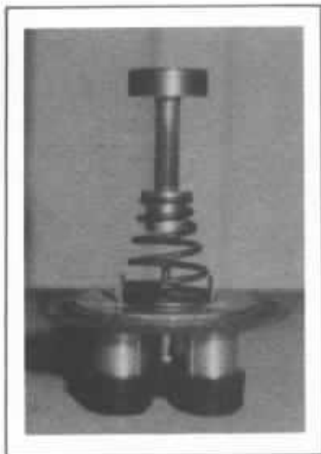
Fig 4 : Détail d'un pied amortisseur. La partie filetée supérieure se visse dans l'insert de la contre-platine et permet le réglage en hauteur.
