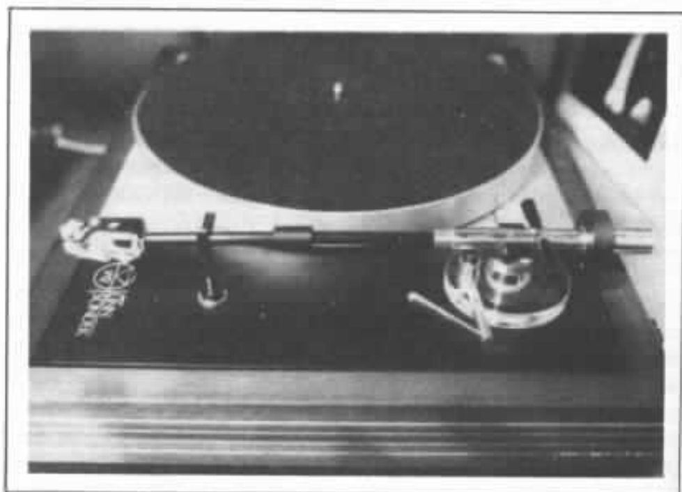
Exemple d'un bras dont tous les paramètres sont réglables, le bras Lurne.
