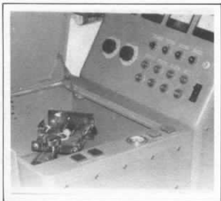
12. Four à induction permettant la fusion instantanée du métal choisi et l'introduction du métal fondu dans le moule. Le tout est soumis ensuite à un mouvement rotatif rapide, l'opération pouvant se faire éventuellement sous vide. Ce four permet d'obtenir, instantanément, pour de petits volumes, des températures dépassant 2\ 800^{\circ}\text{C} .
