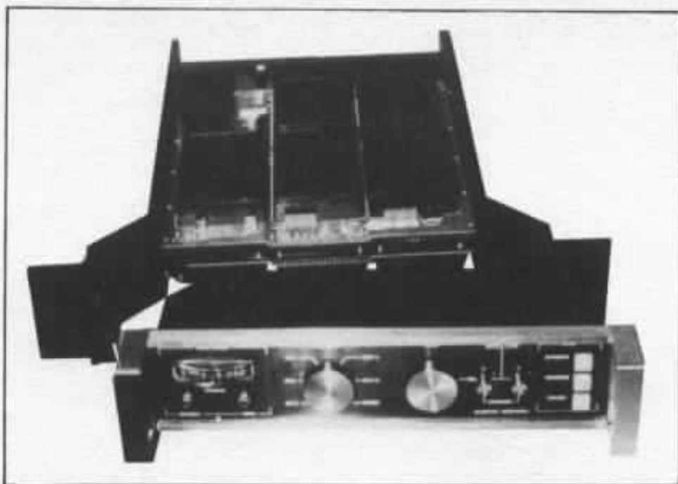
La face avant du préamplificateur EK 1 « s'enfiche » directement sur les circuits imprimés.
