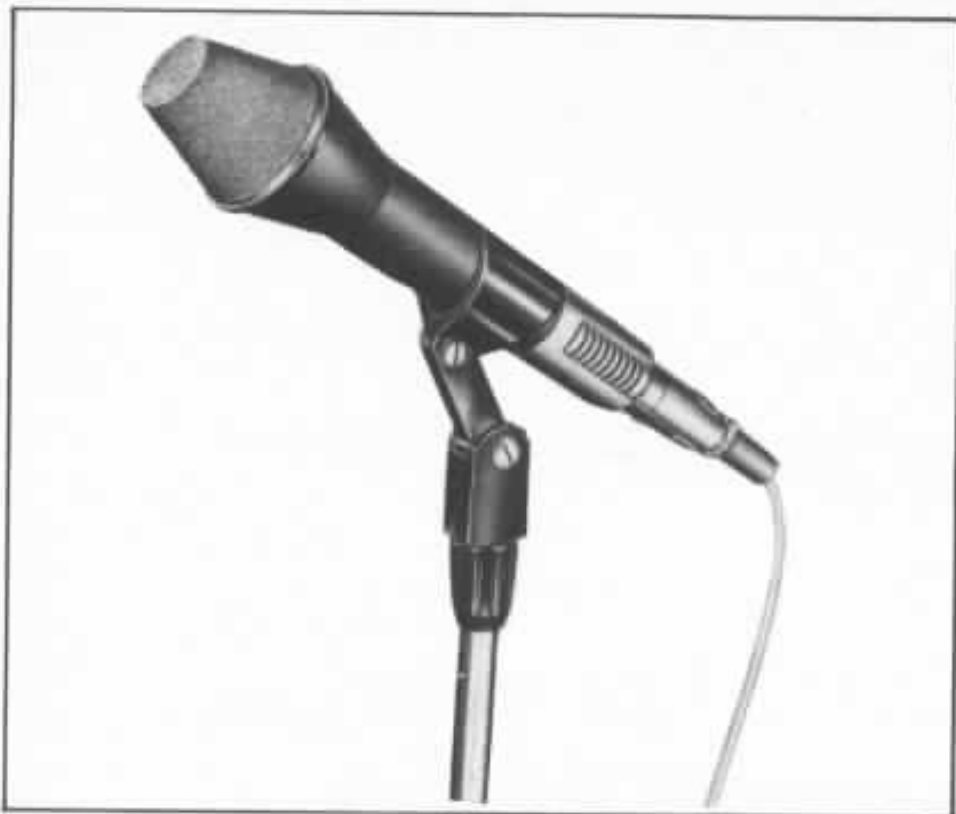
Micro électrodynamique AKG 202 à deux capsules placées dans une calotte en bronze fritté : l'une pour les fréquences aiguës de 800 à 17 000 Hertz, l'autre pour les graves de 20 à 800 Hertz (sensibilité : 0,16 mV/bar doit 1,6 mV/Pa).
