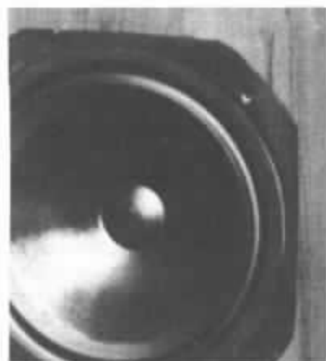
Vue de détail du montage du 10CO-1 sur la mini-Onken. A l'inverse des deux autres caissons, le haut-parleur est monté par l'avant. Le saladier s'encastre sur le baffle.
