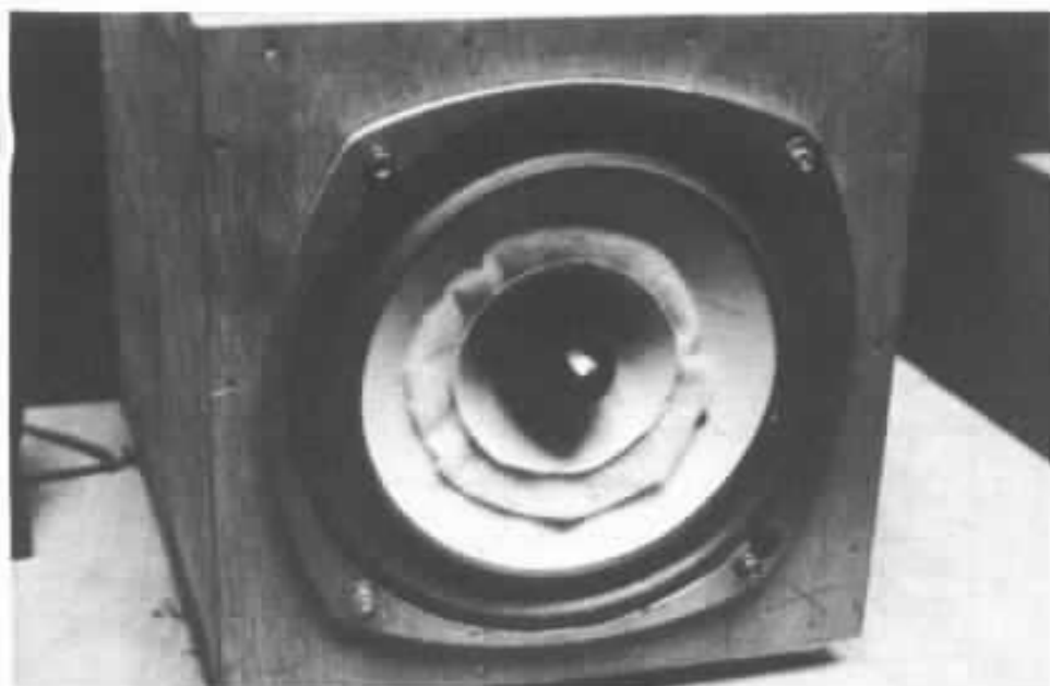
Vue de détail de la modification du Lowther PM6, le bicône est raccourci d'environ 1 cm, une couronne d'amortissement est placée entre le cône principal et le bicône.
