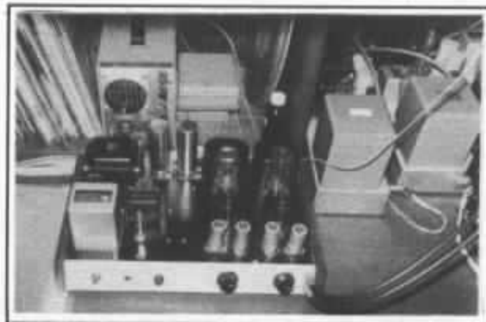
Détail de l'amplificateur d'extrême-aigu bâti autour des tubes 2A3 et du transformateur de sortie « Lux ».
