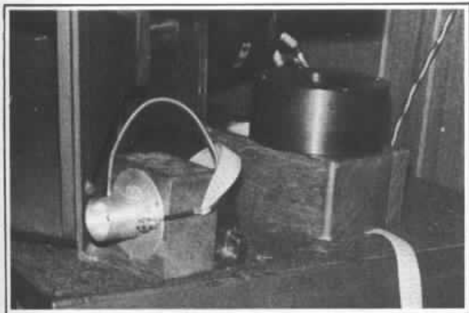
Le super-tweeter Kato « Mushroom Bell » du système Tanaka. Ces tweeters sont alimentés par du fil en nappe « spécial informatique ».
