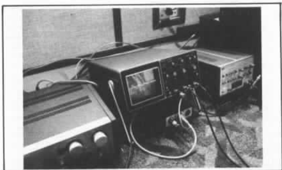
Banc de mesure. Ici oscillo-alimentation et géné. impulsionnel.
