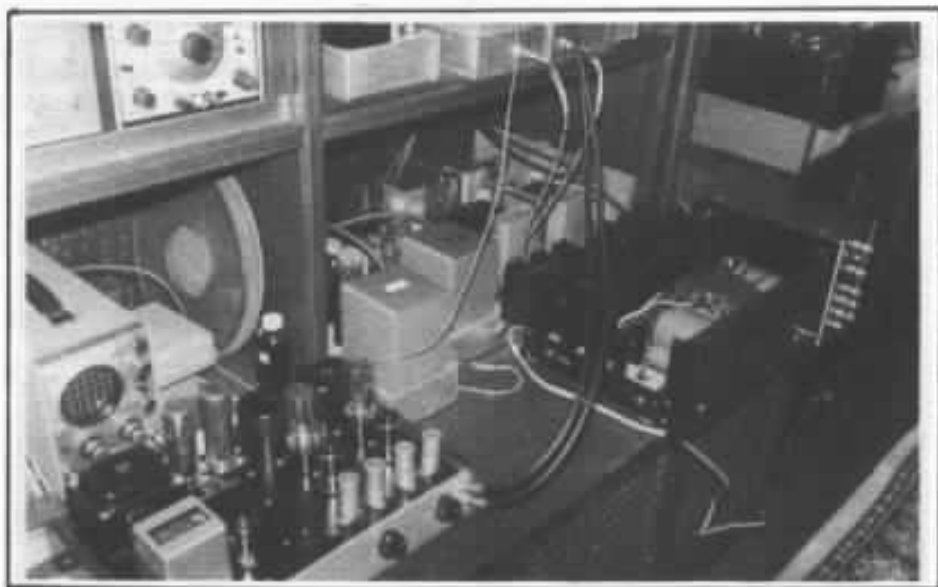
Les amplificateurs de puissance du « système Tanaka ». Au premier plan à gauche le nouvel amplificateur d'extrême aigu. A droite l'amplificateur Kaneda 2 x 50 watts, classe A.
