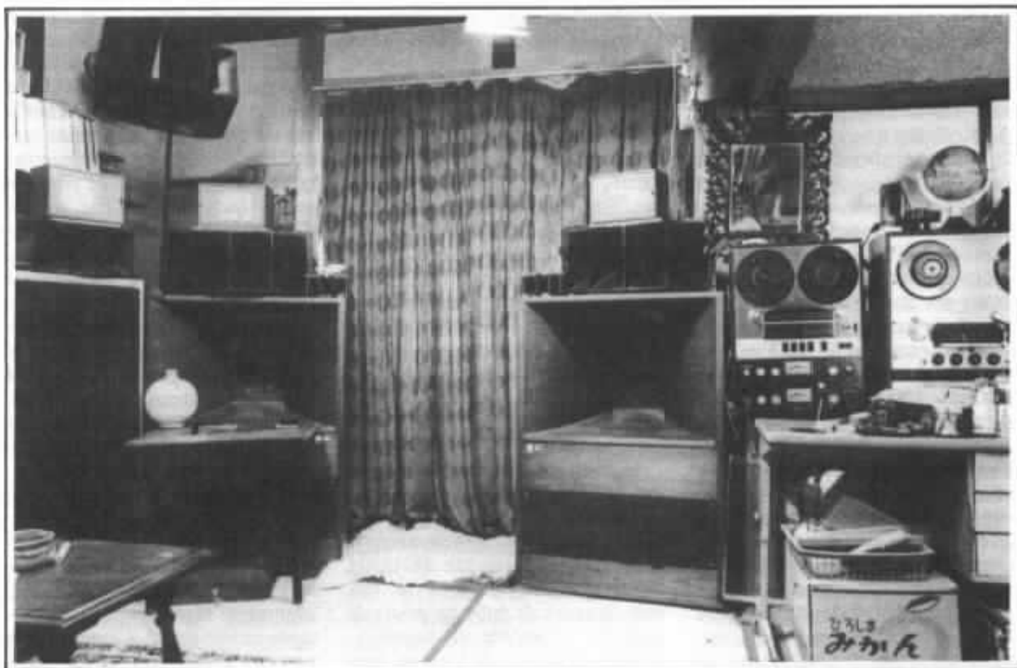
Le système de M. Okada, en 1973 : enceintes Altec «Voix du théâtre», tweeters à chambre de compression et électrostatiques. A gauche, une partie d'un second système disposé orthogonalement par rapport au premier. On remarque en haut et à gauche les pavillons de chambres de compression d'origine Kato.
