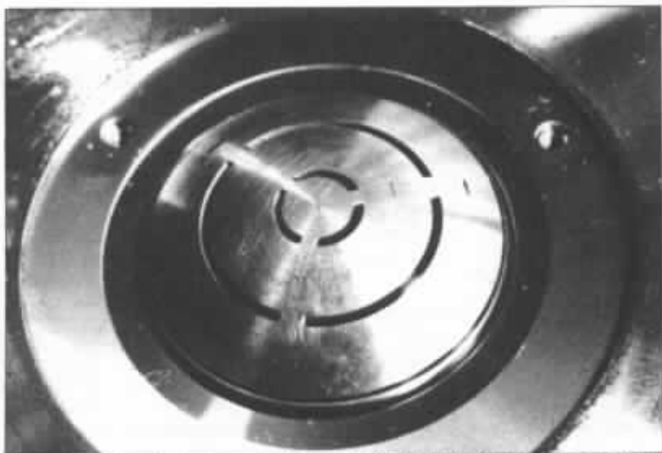
Photo 8 : Pièce de phase concentrique du TAD 2001. Remarquer la présence d'un troisième fente toute proche de l'entrefer. Le matériau est un alliage à haute densité.
