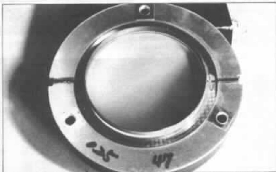
Photo 2 : Équipage mobile du TAD 2001 : remarquer la finesse du grain de la membrane en Beryllium, ainsi que la suspension rapportée en mylar.
