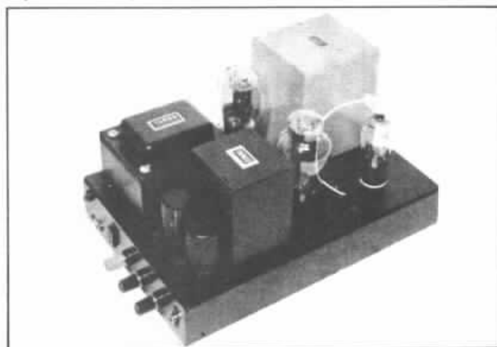
Photo 2 : Réalisation japonaise d'un amplificateur 300 B avec transformateur de sortie Partridge TH 4663.
