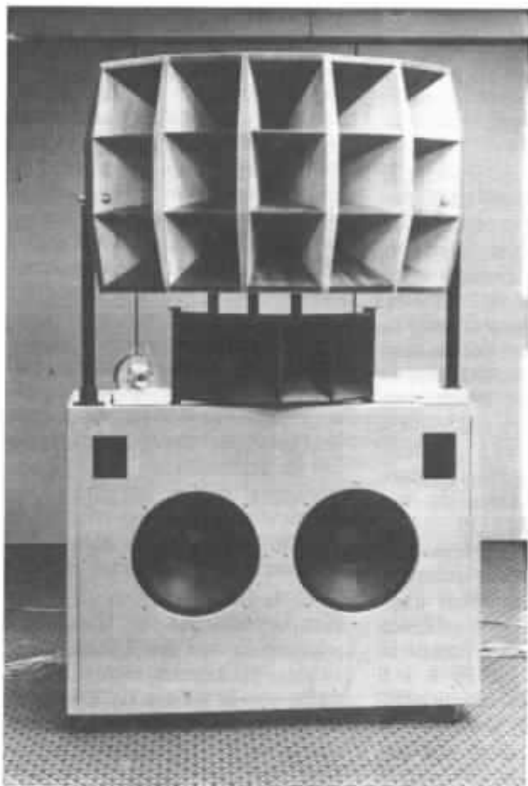
Fig. 18 : Système Onken 4 voies présenté en mars dernier au Sofitel. Celui-ci était «alimenté» de la manière suivante : platine Micro 5000, bras SME 3012, cellule Denon DL 103, prépréamplificateur Le Prépré, préamplificateur Le Solstice, filtre actif Kanéda 240 Hz-1 200 Hz-8 000 Hz, amplificateur de grave prototype Mosfet 120 W, amplificateur de bas-médium Le Classe A, amplificateur de médium Hiraga Classe A, amplificateur d'aigu Némésis. Le câblage est intégralement réalisé en Isoda, y compris le bras de lecture.
