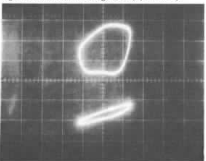
Fig. 56c : Test à 10 kHz (0,5 A eff.). Horizontalement, courant dans la charge (0,5 A/div.). En haut, distorsion au distorsiomètre différentiel (0,1 V/div.), en bas, signal en sortie du montage testé (0,5 V/div.).
