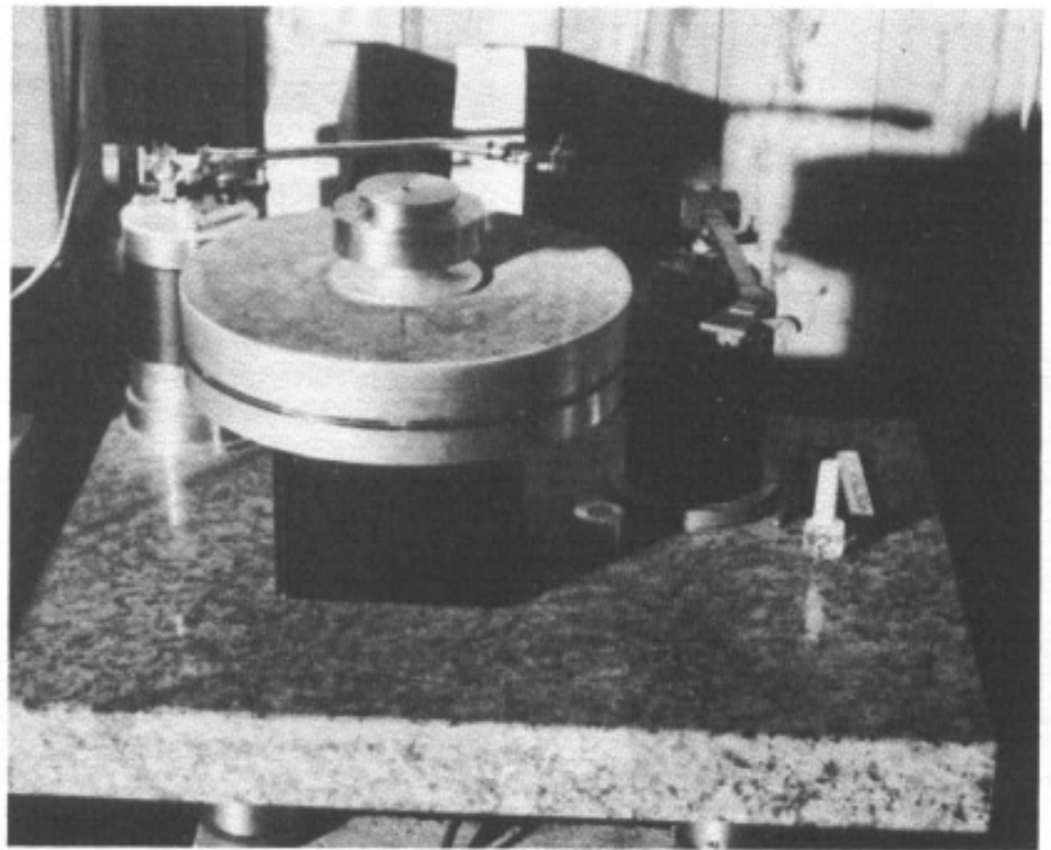
Photo 7 : Platine inspirée de la Verdier, bras Microtrac, Denon 103.
