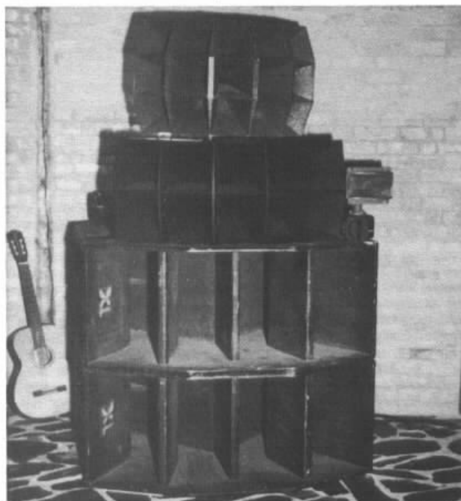
Photo 2 : Système actuel en cinq voies utilisant l'enceinte « Butterfly ».
