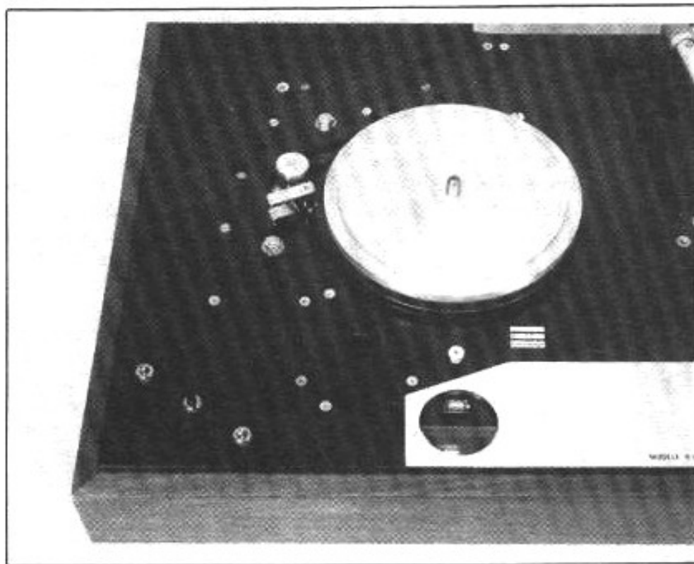
L'entraînement s'effectue par courroie. La fourchette est fixe et ne sert qu'au bon guidage de la courroie. Le changement de vitesse s'effectue électroniquement.
