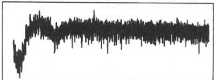
Fig. 17 : Spectre de distorsion en boucle ouverte de la voie n° 2 à 1 kHz ( V_{ov} = 1,5 V_{eff} , R = 8 \Omega ) ; distorsion totale = -71,5 dB ou 0,027 % ; H2 = -89 dB.
