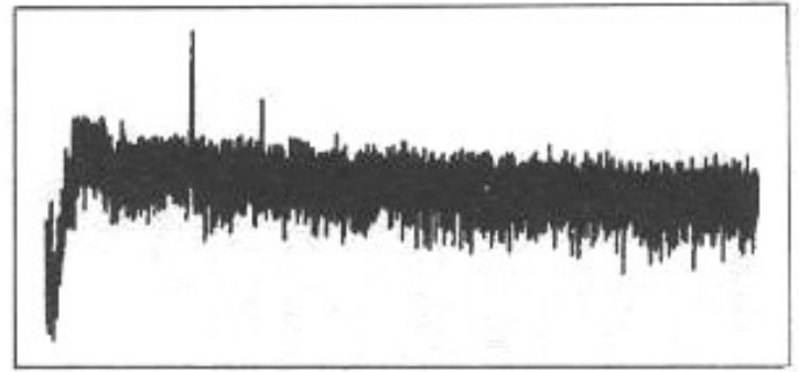
Fig. 28 : Spectre de distortion en boucle ouverte de la voie n° 2 à 1 kHz ( V_{om} = 5 V_{eff} , R = 4 \Omega ) ; distortion totale = -78 dB ou 0,013 % ; H2 = -80 dB, H3 = -98 dB.
