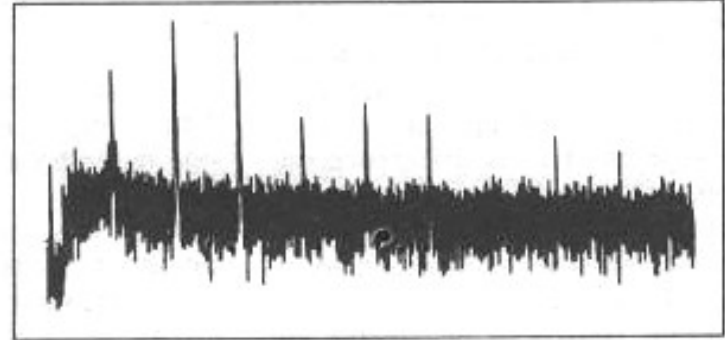
Fig. 34 : Spectre de distortion en boucle ouverte de la voie n° 2 à 1 kHz ( V_{om} = 18 V_{eff} , sans charge) ; distortion totale = -65,5 dB ou 0,053 % ; H2 = -68 dB, H3 = -72 dB, H4 = -94 dB, H5 = -85 dB, H6 = -107 dB, H7 = -100 dB, H8 = -118 dB, H9 = -112 dB.
