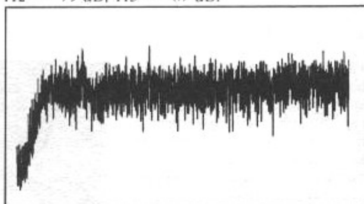
Fig. 42 : Spectre de distortion en boucle fermée de la voie n° 2 à 1 kHz ( V_{out} = 5 V_{eff} , sans charge) ; distortion totale = -70 dB ou 0,032 % ; H2 = -102 dB.
