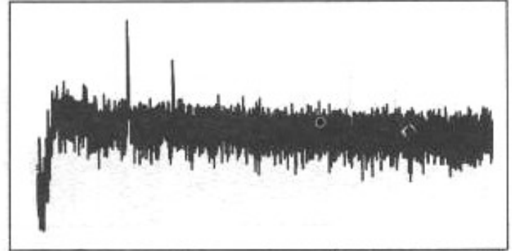
Fig. 30 : Spectre de distortion en boucle ouverte de la voie n° 2 à 1 kHz ( V_{om} = 7 V_{eff} , R = 4 \Omega ) ; distortion totale = -76 dB ou 0,016 % ; H2 = -78 dB, H3 = -94 dB, H4 = -108 dB, H5 = -109 dB.
