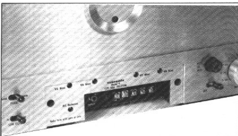
La trappe a été retirée laissant apparaître la prise d'entrée Cinch, les borniers de sortie haut-parleurs et les vis de réglage des tensions de polarisation ainsi que l'équilibre du courant continu.
