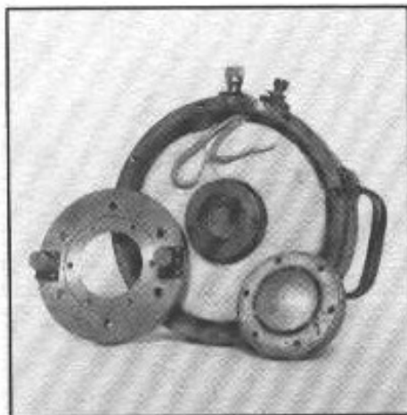
Moteur Western Electric 555 W démonté. Remarquer la taille de la bobine d'excitation.
