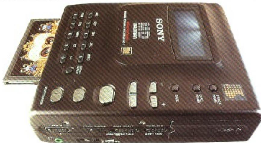
*sonore de ce nouveau support numérique est excellente, avec une absence totale de souffle, d'irrégularités de fonctionnement même en secouant le lecteur (grâce à une mémoire tampon). L'accès aux plages choisies, est instantané. Par le principe de disque optique, il n'y a pas de contact et les risques d'usures sont écartés. La durée dans le temps de l'enregistrement numérique sans pertes de qualité est pour ainsi dire infinie.*
