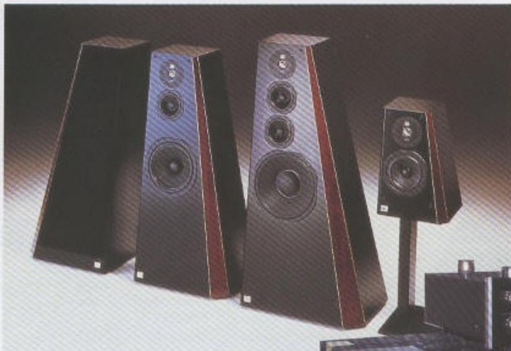
La nouvelle série TI de JBL avec les trois modèles 1000, 3000 et 5000 dont le design rappelle la 250 TI. Les parois des coffrets sont hyper-rigides avec un sandwich de panneaux de haute densité séparés par une couche de bitume de 3 mm.
