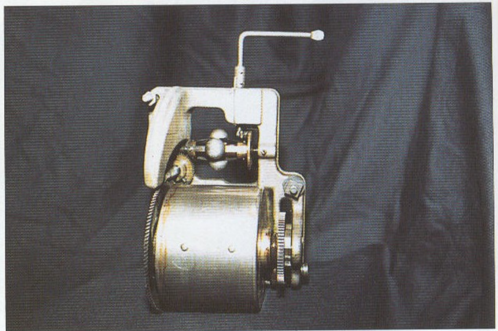
Photos 3 et 4 : moteur Gramophone (1920). Ce moteur possède deux ressorts - d'où l'importance du barillet - et un châssis en fonte moulé d'une seule pièce.
