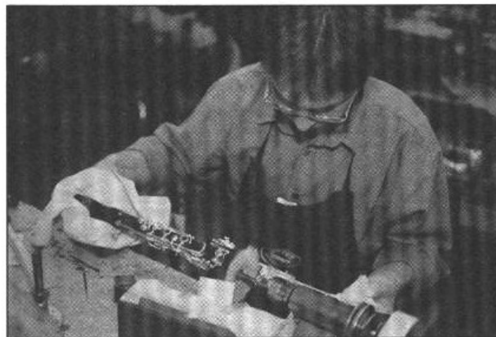
Dernier avivage des spatules de clés.
