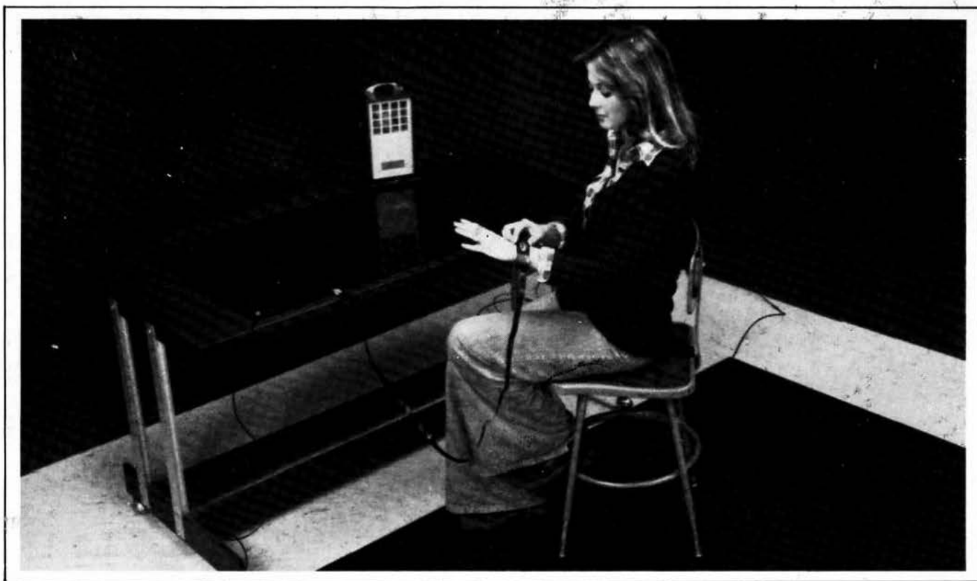
Le poste de travail en matériau 3M Vélostat : dessus de table, tapis de sol, bracelet d'opérateur et soufflerie ionisante.
