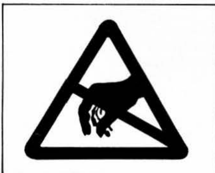
Fig. 4. – Symbole international servant à signaler les zones sous contrôle antistatique.
