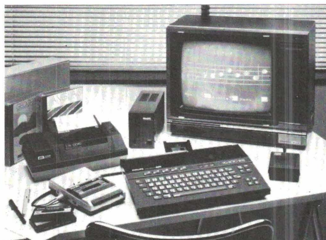
Unité centrale, micro-ordinateur, visualisation, lecteur de disquettes et de cassettes, imprimante : une « configuration » complète.
