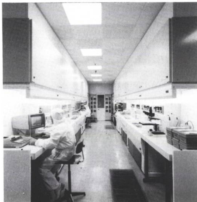
Unité centrale de commande du four de diffusion 4''.
