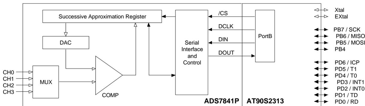
Le pilotage de U2 se fait grâce aux lignes PB0 à PB3. On perd de ce fait les deux entrées du comparateur analogique, une ligne simple et la sortie du *Timer*. Il reste 10 entrées – sorties disponibles : PD0 à PD6 (partagées avec les *Timers* / Interruptions externes / UART), PB4 à PB7 (partagées avec l'interface ISP). On retrouvera évidemment les quatre entrées analogiques Ain0 à Ain3, la broche /RESET, VCC et GND pour l'alimentation +5V.
