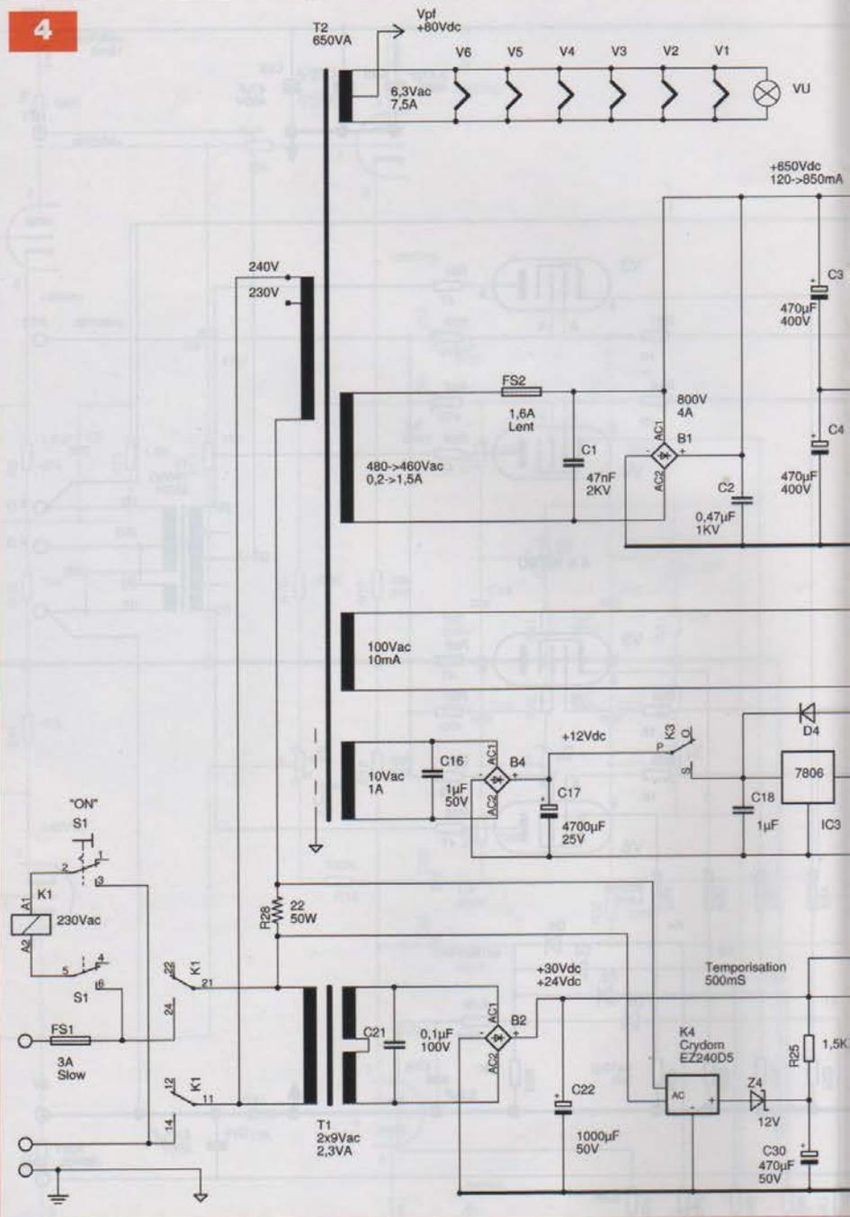
(R47 à R50). Un courant de 25 mA développe une tension de +250 mVdc dans les 10 Ω, elle chute de 85 mVdc dans les 330 Ω pour piloter le vumètre.
