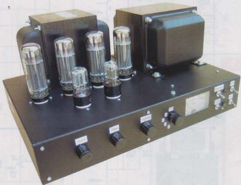
Le signal est découplé et injecté sur la grille en broche (4) de la 6SL7 (V1B). Le gain de cet étage est de 36 dB sans contre-réaction. Le tube 6SN7 (V2A) est monté en cathode suivieuse et le couplage V1B vers V2A est direct. La polarisation de grille des deux éléments du premier tube (V1) est fixée à 38 Vdc par le pont diviseur R4/R5. Ceci nous permet de limiter les variations du point de fon-
