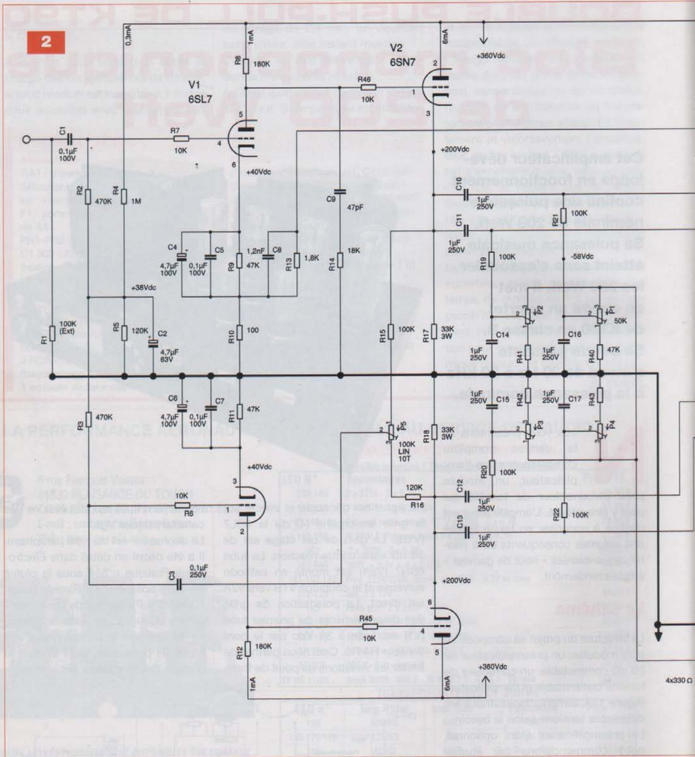
Son réglage permet de réduire le taux de distorsion à son minimum. Les deux signaux déphasés se retrouvent aux cathodes de la 6SN7 (V2). L'avantage de ce type de circuit réside dans une parfaite symétrie et une attaque des tubes de puissance à basse impédance, ce qui est indispensable pour l'attaque en courant du push-pull.
