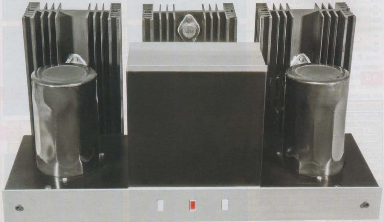
Nous abordons ici l'étude et la réalisation d'un amplificateur capable de fournir 2 x 52 Weff sur charges de 8 Ω. Cet appareil fonctionne en pure classe A et en Single end.
