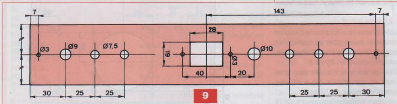
dans les côtés seront avantageusement taraudés. Dans ce cas, les perçages se feront à  $\varnothing 3,3$  mm (taraud M4, foret-pilote M3,3). Il en est de même pour celui situé au centre et à 15 mm du bas du dissipateur (fixation du pont redresseur).
