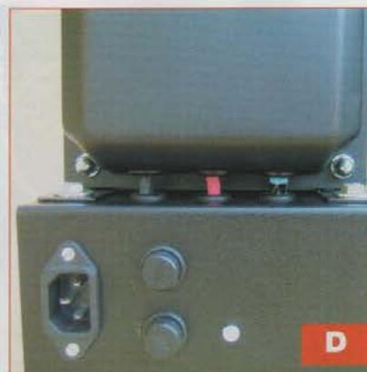
Le transformateur d'alimentation est livré avec les deux capots séparés. Il y a lieu de percer trois trous de 14 mm dans un des capots pour permettre le passage des fils. On perce les mêmes trous en vis-à-vis dans le châssis. Ces trous sont protégés par des passe-fils (**photo D**). Le transformateur et les capots ont été peints par l'auteur en noir satiné.
