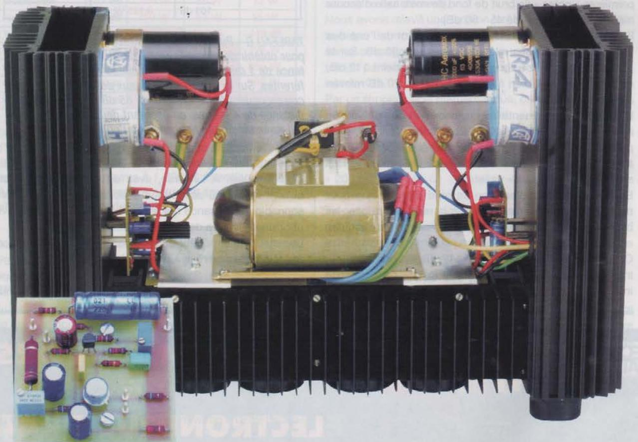
Bien souvent, la complexité de l'étude et de la réalisation d'un amplificateur fonctionnant en « pure classe A » ne se situe pas au niveau de l'électronique, mais sur le plan de la mécanique. Si l'on désire disposer d'une réserve de puissance de 2 x 20 Weff à 2 x 30 Weff, la consommation permanente de plusieurs ampères, même au repos, entraîne un échauffement considérable d'une bonne partie de l'électronique (transistors de puissance, transformateur, pont de redressement...).
