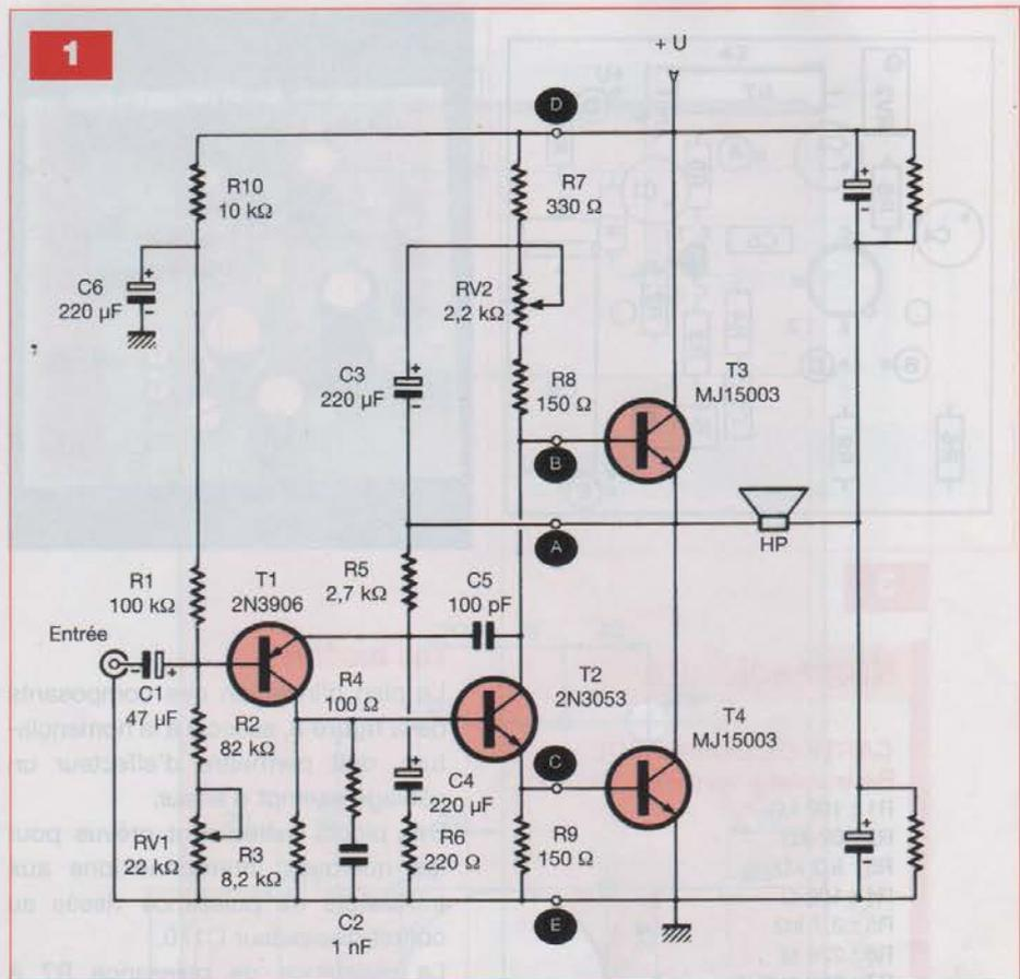
de régler le courant de repos de l'amplificateur. Lequel circule dans les deux transistors de puissance reliés en série. Au point milieu de T3 et T4, nous mesurons la moitié de la tension d'alimentation (ou presque), le réglage à  $U/2$  étant « peaufiné » avec l'ajustable RV1.
