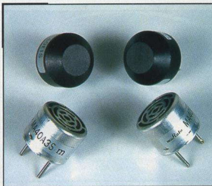
► Capteurs à ultrasons MURATA, ceux du haut sont étanches...
