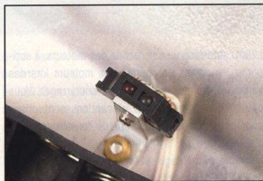
► Le capteur à réflexion placé sous le châssis.
