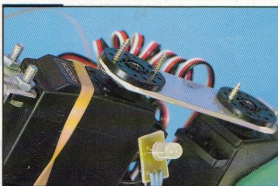
Fixation des servos entre eux. Au premier plan, l'œil constitué d'une diode LED tricolore.
