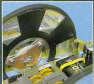
► Mécanique : Une roue à codeur
