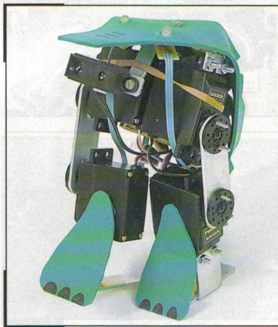
Le dragon se réalise avec l'assemblage de quatre servomécanismes et quelques pièces d'aluminium.
