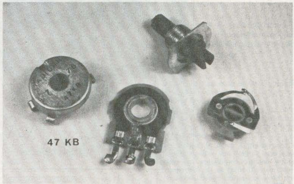
Photo 1. – Les potentiomètres ronds avec de gauche à droite : l'ordinaire à visser, le même avec inter, potentiomètre double, le modèle professionnel à piste moulée, et le potentiomètre à souder avec axe emboîtable.
