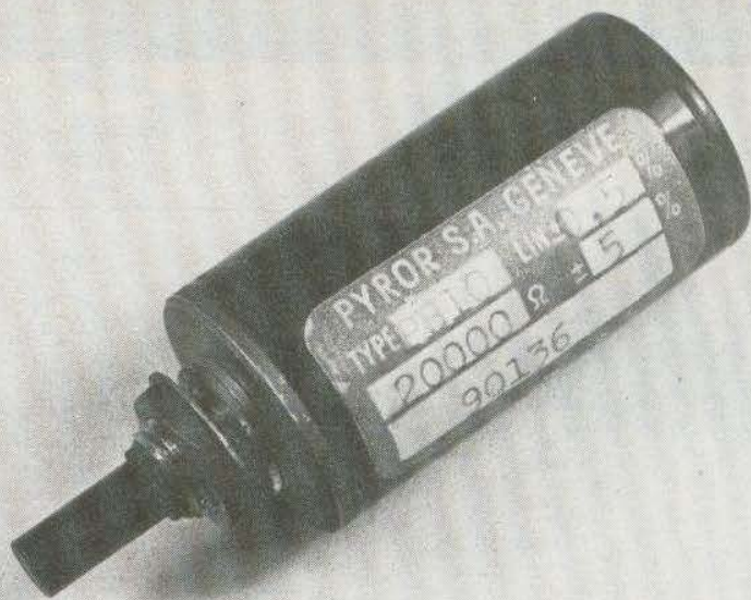
Photo 4. – L'hélipot est un potentiomètre bobiné à piste hélicoïdale. C'est un composant de très haute précision.
