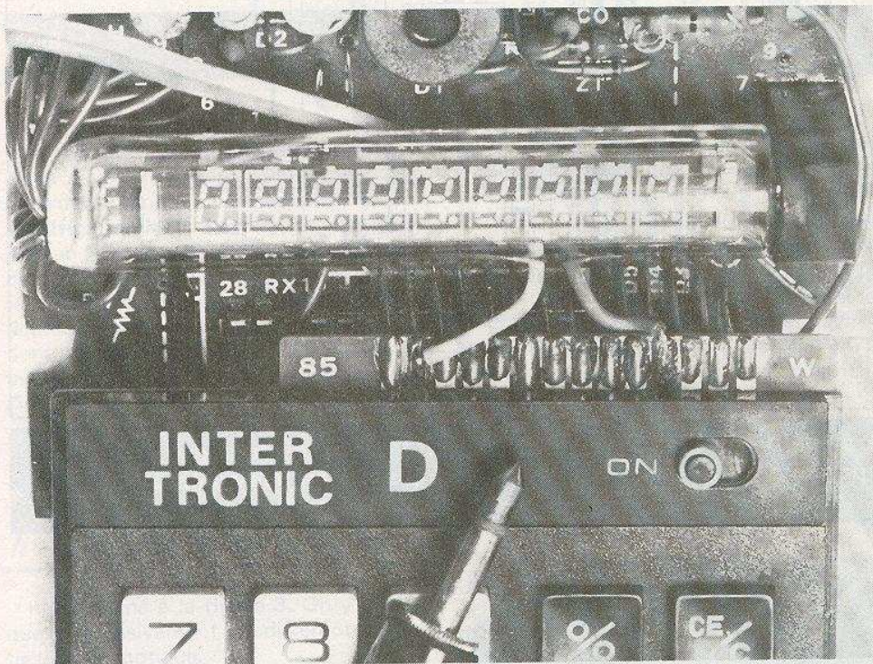
Photo 4. – Après avoir ouvert la calculatrice, on repèrera soigneusement les deux connexions correspondant à la touche « = ».
