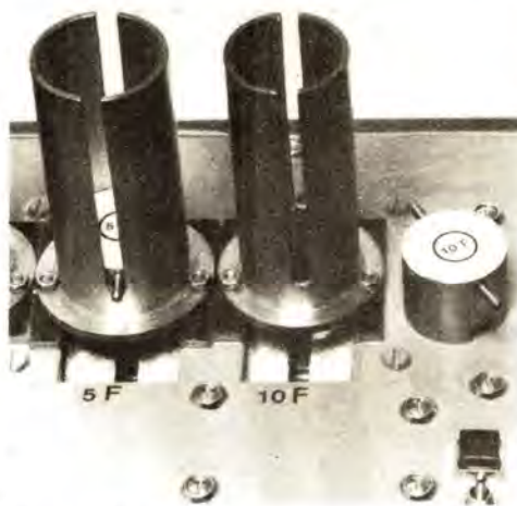
Photo 2. - Un aperçu des deux cylindres destinés à recevoir les pièces de 5 et de 10 F.
