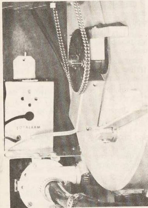
Photo 2. — Un module minuscule pour la LED IR et le phototransistor (BC 109 ouvert).
