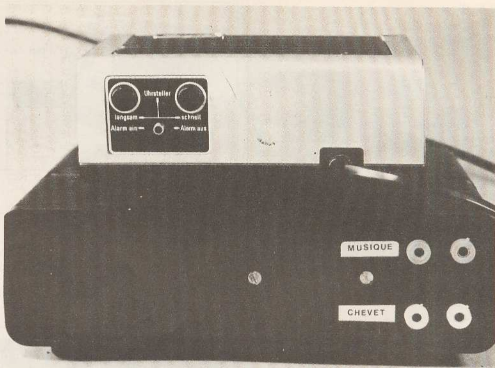
Photo 5. — Sur le panneau arrière, le petit circuit optionnel avec le relais et les douilles bananes.
