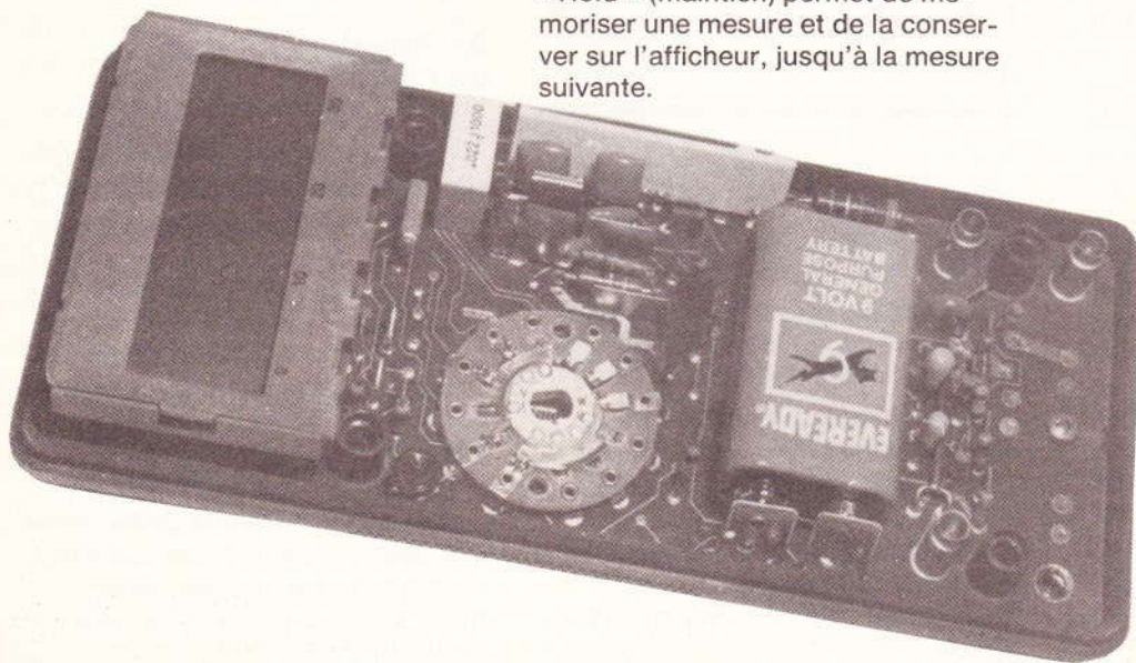
Vue intérieure du multimètre.
