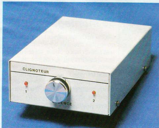
Photo 3. Le montage a été introduit à l'intérieur d'un coffret Retex « Minibox » RM 543.
