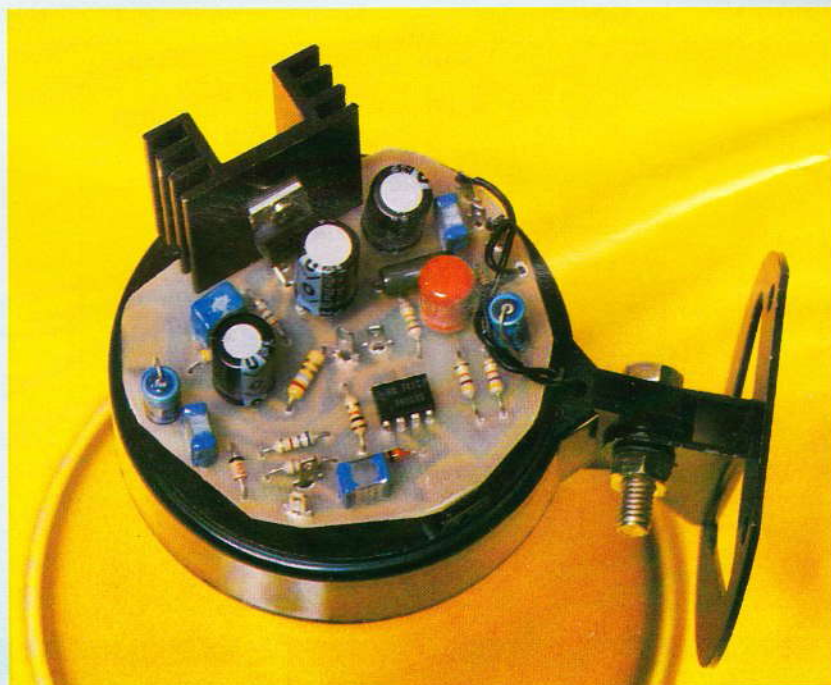
Photo 3. – Montage du circuit imprimé sur le HP.
