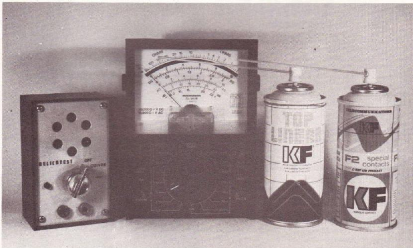
Photo 3. – Le petit arsenal du dépannage : un testeur sonore, un contrôleur et deux bombes « rajeunissantes ».
