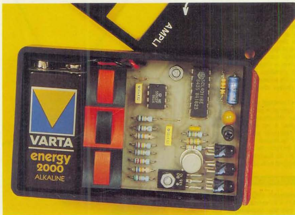
Photo 2. - Vue intérieure du boîtier émetteur.
