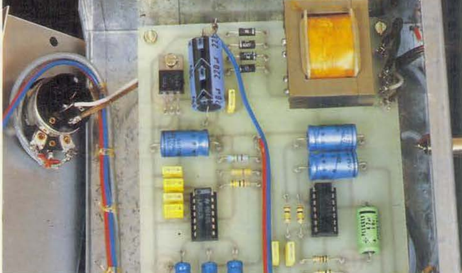
Photo 3. - La section alimentation, avec le transformateur.
