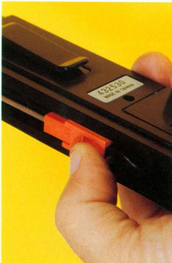
Photo 3. – La sonde coulissant dans une rainure de guidage.
