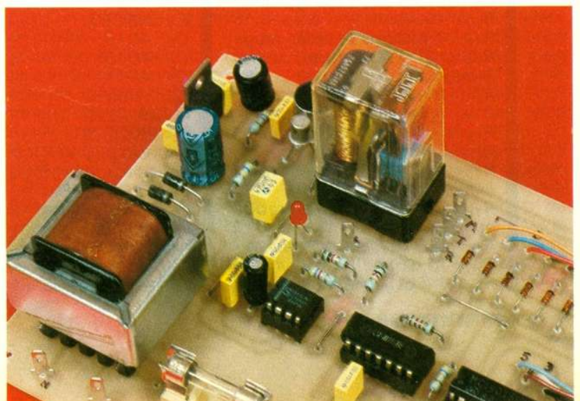
Photo 4. - Vue de la section alimentation comportant le fusible, le transformateur, le redresseur et le filtrage.
