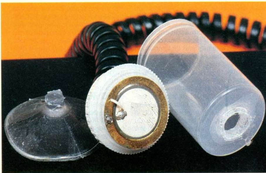
Photo 4. - Vue d'un résonateur piézo-électrique démonté.
