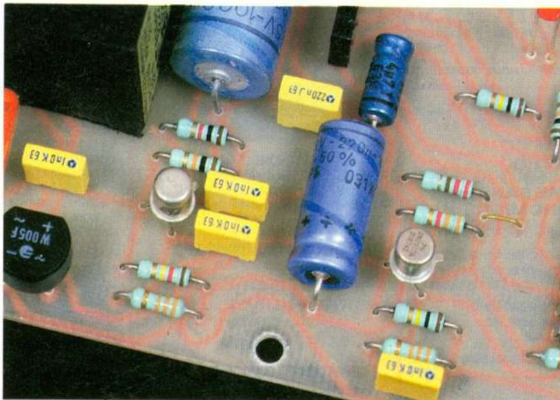
Photo 6. – Au premier plan, le transistor T_2 , assurant l'amplification des signaux codés transitant sur le réseau EDF.
