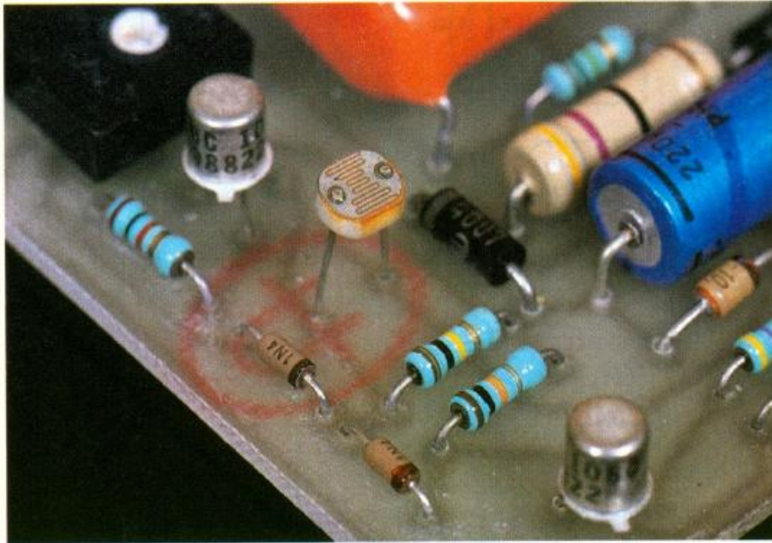
Photo 3. – Gros plan de la photo-résistance retenue.
