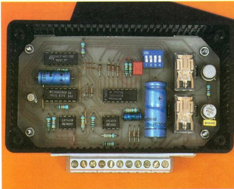
Photo 3. – Le module principal s'insère dans un boîtier Teko pour lequel il a été conçu.
