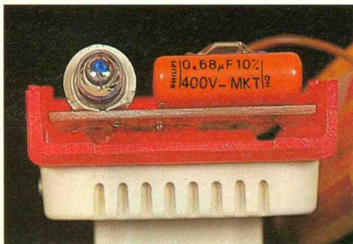
Photo 3. – Gros plan sur la lampe 2,5 V et le condensateur C_1 .
